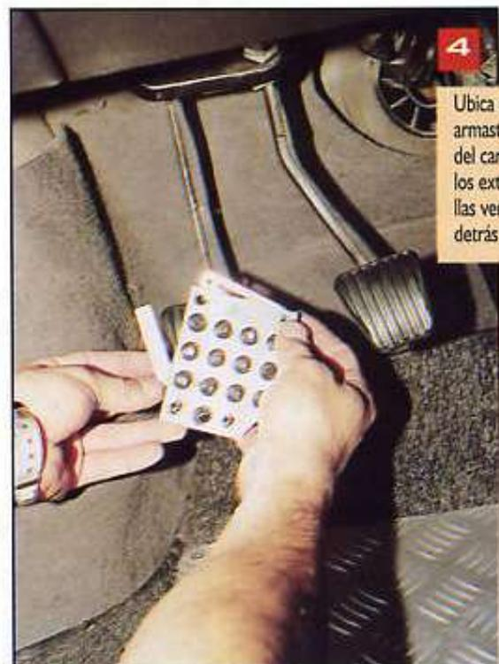
Ubica el cubrepedal que armaste sobre el pedal del carro, recuerda que los extremos de las varillas verticales deben ir detrás de la horizontal.
