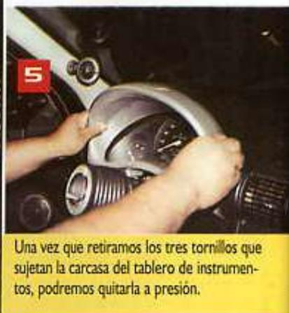
**5** Una vez que retiramos los tres tornillos que sujetan la carcasa del tablero de instrumentos, podremos quitarla a presión.
