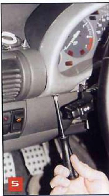
5 Con el mismo desarmador de cruz, retiramos los dos tornillos que sujetan el marco del tablero.
