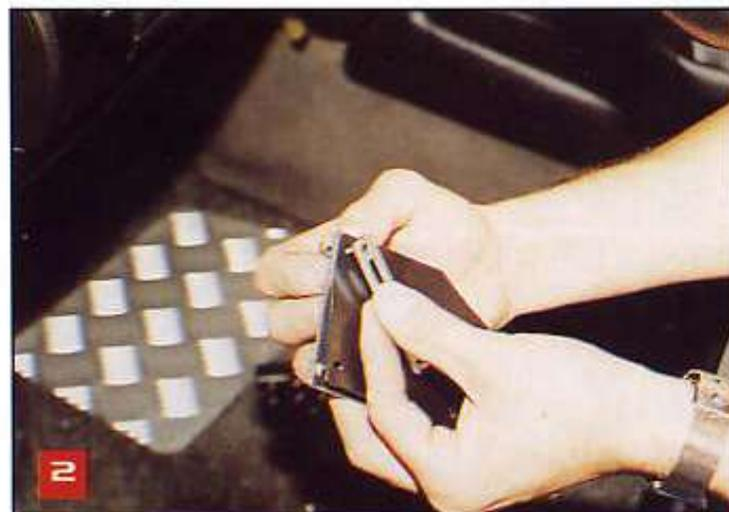
Empieza instalando el cubrepedal que corresponde al clutch. Para ello debes armar la base del pedal, la cual se compone de tres varillas: una horizontal que tiene dos orificios para tornillos y las dos verticales que cuentan con un orificio. Primero coloca, únicamente, uno de los tornillos de la varilla que va horizontal, con el objeto de que puedas manejar el cubrepedal sin problemas (no lo aprietes por completo).
