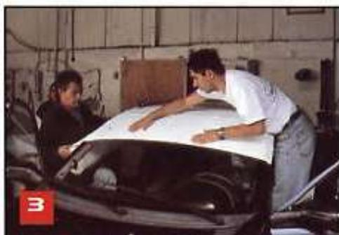
**3** Ahora se procede a colocar plástico industrial sobre el toldo y parte del parabrisas del vehículo, este tipo de material se adhiere perfectamente al contorno de la lámina.
