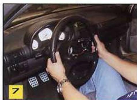
**7** Retiramos el volante manualmente, como se muestra en la imagen.
