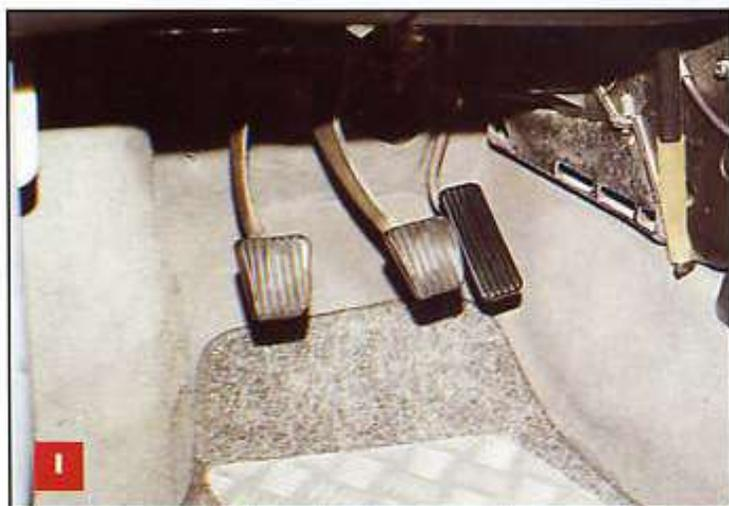
Estos son los pedales que originalmente tienen todos los Chevys, se encuentran cubiertos por gomas de hule que debes cambiar de manera constante debido al desgaste. Los nuevos cubrepedales se instalan sobre dichas gomas para que queden bien adaptados.
