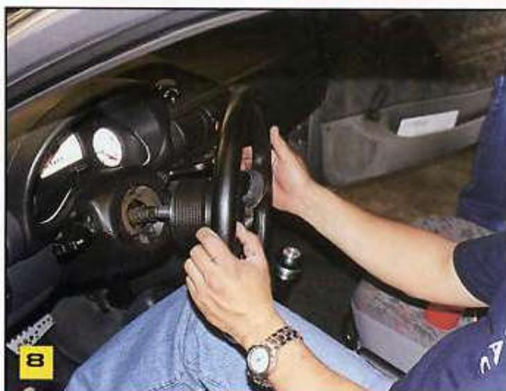
**8** Si tienes problemas para retirarlo, deberás moverlo de un lado a otro hasta que salga completamente.
