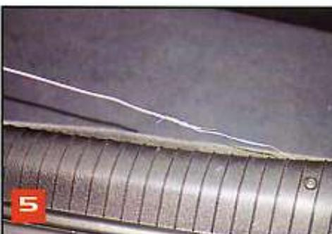
5 Podemos auxiliarnos de una guía (alambre poco maleable) para pasar los cables que incluiremos en nuestra instalación sin necesidad de desmontar tapas y tolvas interiores.
