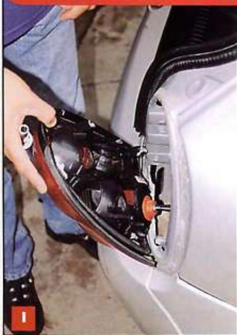
1 Se retiran los circuitos de las calaveras (donde van montados los focos) desconectando el arnés que va al circuito, y posteriormente las calaveras. Para esto necesitaremos un dado de 8 mm y una llave española también de 8 mm para remover los 4 tornillos que las sujetan. Uno de estos tornillos, el de la calavera derecha, ubicado en la parte inferior izquierda, es de difícil acceso, para removerlo ocuparemos la llave española (de preferencia estriada).
