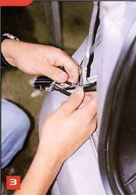
3 Ahora retiramos la cinta de aislar que trae el conjunto de cables que van al arnés de conexión con el fin de identificar el orificio vacío de este conector.
