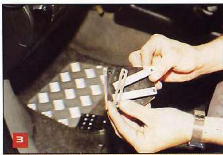
Coloca los tornillos de las dos varillas verticales, después pásalas detrás de la horizontal.
