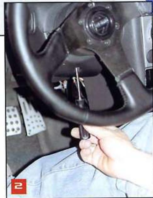
2 Con un desarmador de cruz retiramos los dos tornillos que sujetan las cubiertas del switch.
