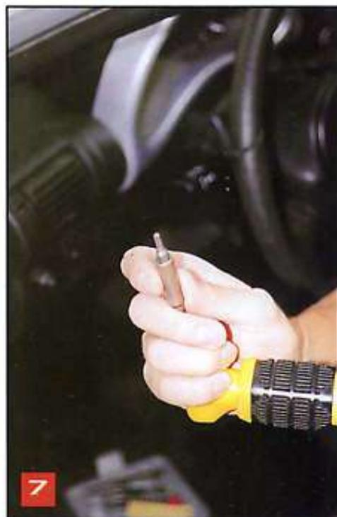
7 Para llevar el cable proveniente de la calavera izquierda al interruptor de las luces será necesario remover la tapa de un costado del automóvil para deslizar el cable junto a los existentes, esto se realiza con un desarmador Torx T15.
