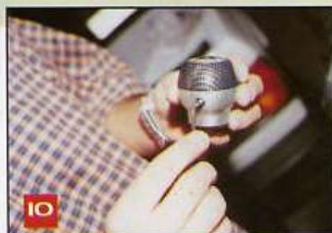
Instala el tornillo dentro de la perilla, sin apretarlo completamente.
