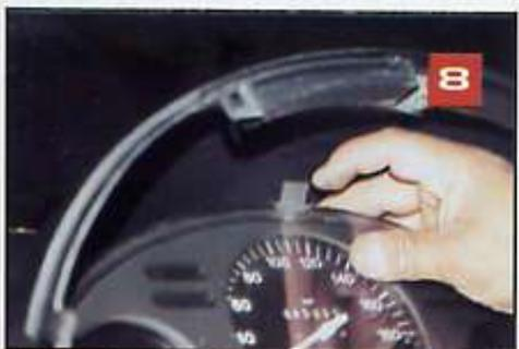
Después de retirar el chicote del acelerador quitamos el tablero de instrumentos cuidando de no dañar la mica, para ello deberás soltar el seguro ubicado en su parte superior
