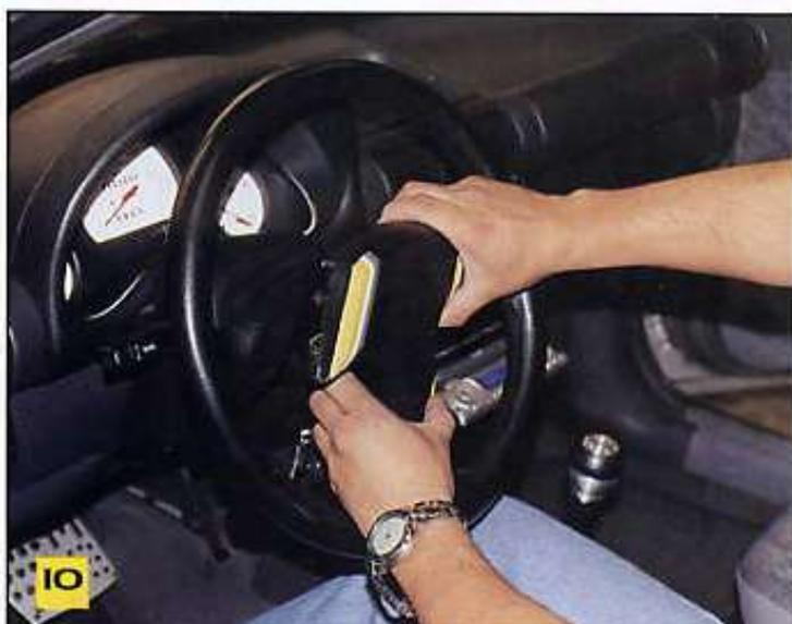
**10** Conecta los cables de corriente del claxon, y procede a colocar la tapa presionándola.
