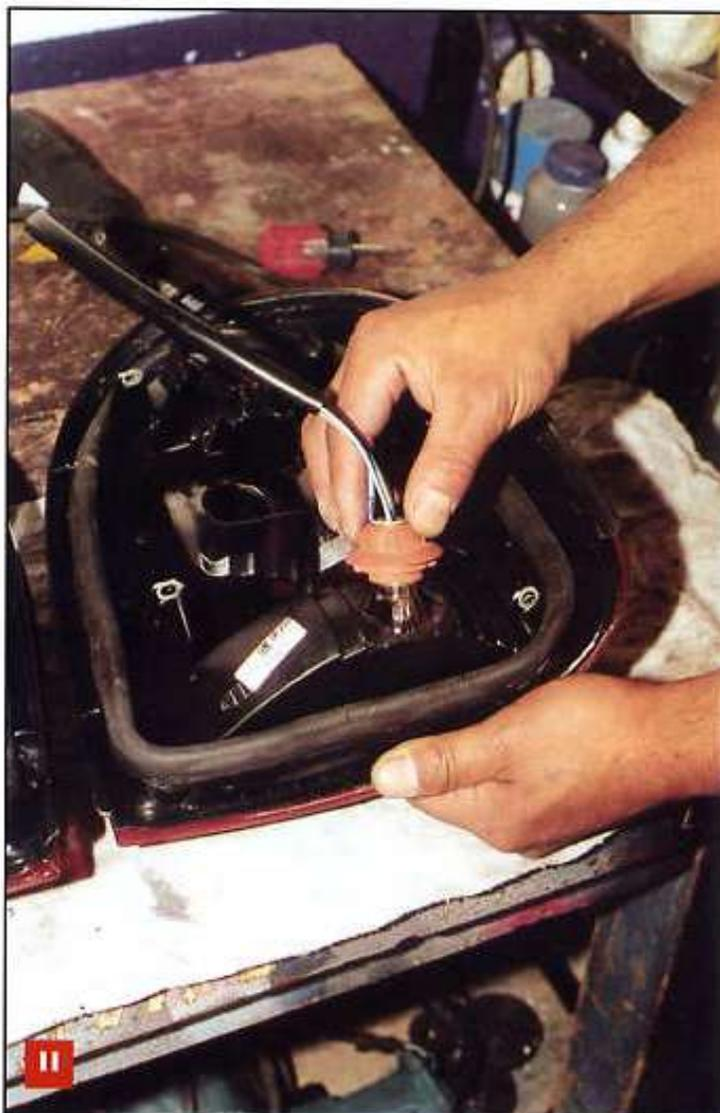
11 Coloca el sóquet en el orificio, oprimiendo con los dedos hasta que entre perfectamente.
