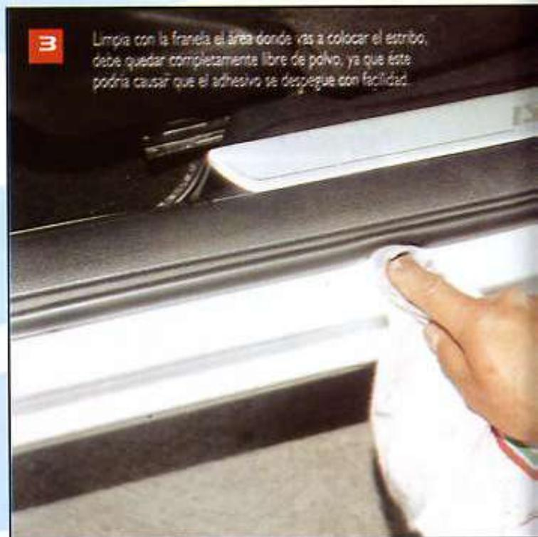
**3** Limpia con la franela el área donde vas a colocar el estribo, debe quedar completamente libre de polvo, ya que éste podría causar que el adhesivo se despegue con facilidad.
