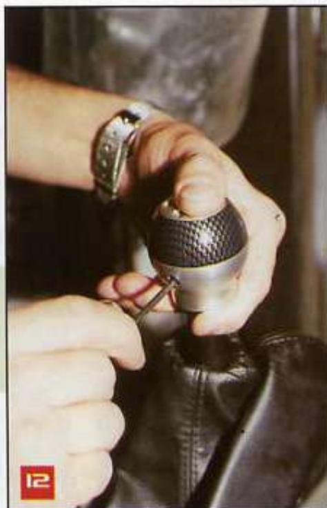
Ya que tenemos el seguro puesto dentro de la alineación de la palanca, únicamente nos resta apretar el tornillo, regularmente éstos son del tipo Allen, si el pomo que adquiriste no incluye la llave, consigue una a la medida del tornillo.
