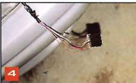
4 Ya libre de la cinta de aislar y totalmente visibles estos cables, empezamos a dirigir nuestro cableado en paralelo al existente, de tal manera que podamos hacer una red como la que se muestra en el diagrama.
