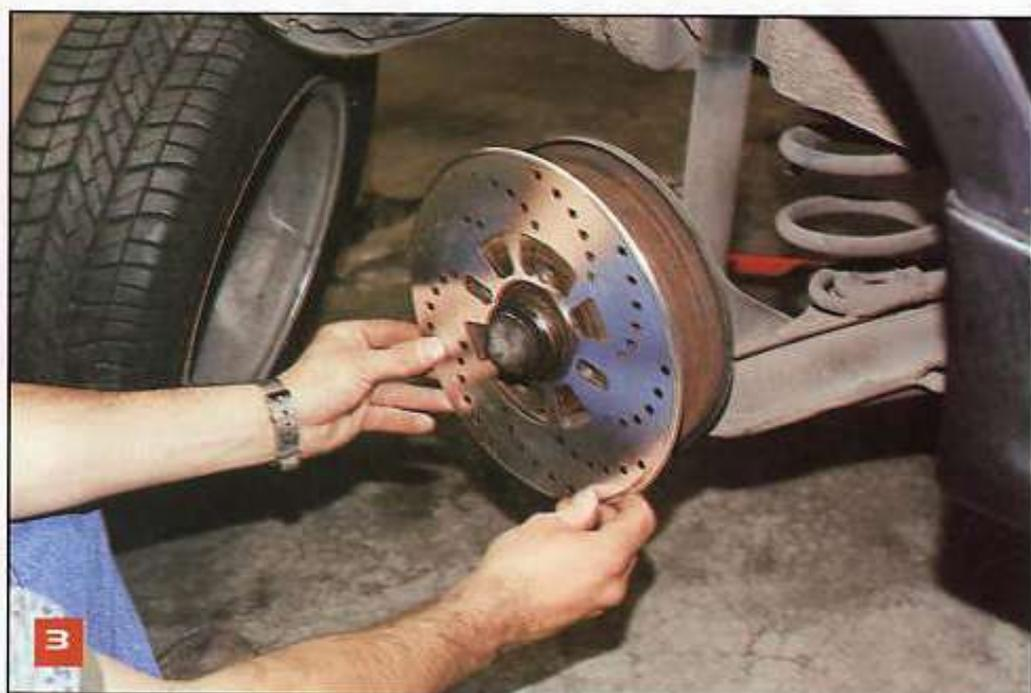
Coloca el disco ventilado sobre el tambor, manteniendo los orificios de los birlos a la vista, como se muestra en la gráfica.
