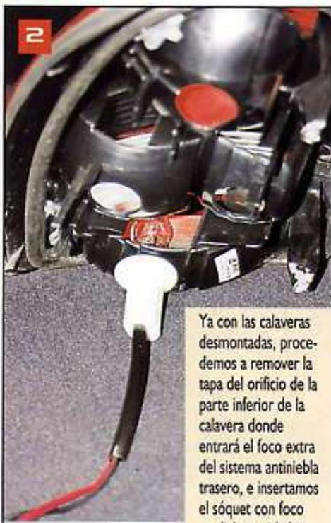
2 Ya con las calaveras desmontadas, procedemos a remover la tapa del orificio de la parte inferior de la calavera donde entrará el foco extra del sistema antiniebla trasero, e insertamos el sóquet con foco en dicha cavidad.
