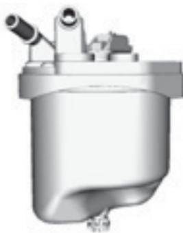
**Nota:** La bomba incorporada en el tanque de combustible se desconectará automáticamente transcurridos aproximadamente 40 segundos.
