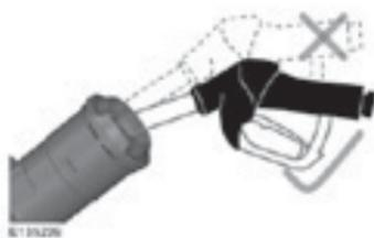
Introduzca la boquilla del surtidor hasta la primera muesca, y manténgala en esa posición en la boca de llenado de combustible.
