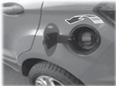
El tapón del tanque de combustible tiene un diseño de giro regular, que necesita dos a tres giros para retirarlo o colocarlo. Cuando llene el tanque de combustible de su vehículo:
