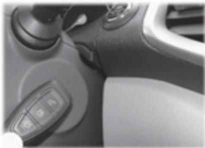
1. Sostenga la llave junto a la cubierta de la columna de dirección exactamente como se muestra.
