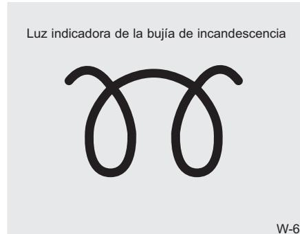
3. Gire la llave de contacto a la posición ON para precalentar el motor. La luz indicadora de la bujía de incandescencia se iluminará.
