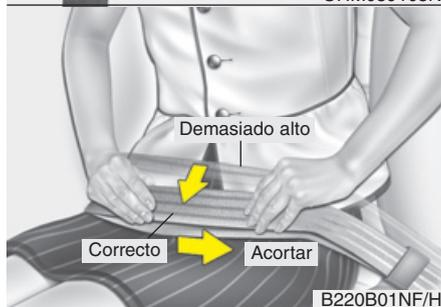
Con los cinturones estáticos de 2 puntos de anclaje hay que ajustar la longitud manualmente para que se ciña al cuerpo. Enganche el cinturón y tire del extremo libre para apretarlo. Coloque el cinturón tan bajo sobre las caderas como pueda, no en la cintura. Si el cinturón está demasiado alto, aumenta la probabilidad de sufrir lesiones en caso de accidente.
