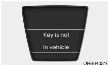
Si la llave smart no está en el vehículo y si se abre o se cierra alguna puerta con el interruptor de encendido en posición ACC, ON o START, la advertencia ilumina la pantalla LCD. La señal acústica también suena durante 5 segundos cuando la llave smart no está en el vehículo y se cierra alguna de las puertas.
