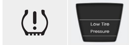
Cuando se ilumina el indicador de advertencia del sistema de control de la presión de los neumáticos y se visualiza un mensaje de advertencia en la pantalla LCD del tablero, uno o varios neumáticos están por debajo de la presión adecuada.
