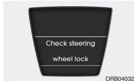
Cuando el volante no está bloqueado, la advertencia se ilumina durante 10 segundos en la pantalla LCD.
