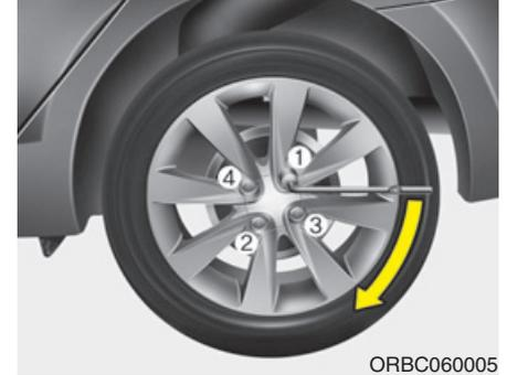
Coloque después la llave como se muestra en la figura y apriete las tuercas de la rueda. Asegúrese de que la cazoleta asienta completamente sobre la tuerca. No se ponga de pie sobre la llave ni utilice un tubo para prolongar el brazo de palanca.
