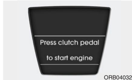
Si el interruptor de encendido se coloca en la posición ACC dos veces mientras se pulsa varias veces el botón de inicio/parada del motor sin pisar el pedal del embrague, la advertencia se iluminará en la pantalla LCD durante 10 segundos para indicar que debe pisar el pedal del embrague para arrancar el motor.
