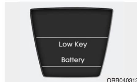
Cuando se descarga la llave smart del vehículo, la advertencia se iluminará en la pantalla LCD durante 10 segundos. Cambie la batería por una nueva. Si no es posible, puede arrancar el motor pulsando el botón de inicio/ parada del motor con la llave smart.
