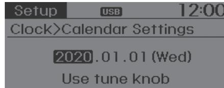
\* Ajuste el número marcado para fijar los ajustes y pulse el mando TUNE para pasar al ajuste siguiente. (Ajustar por el orden de día/mes/año.)
