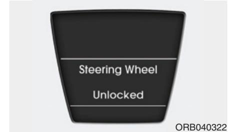
Cuando el volante no está bloqueado, la advertencia se ilumina durante 10 segundos en la pantalla LCD.
