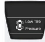
**Dispositivo avisador de posición de la baja presión de los neumáticos**
