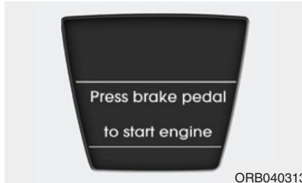
Si el interruptor de encendido se coloca en la posición ACC dos veces mientras se pulsa varias veces el botón de inicio/parada sin pisar el pedal del freno, la luz de advertencia se iluminará en la pantalla LCD durante 10 segundos para indicar que debe pisar el pedal del freno para arrancar el motor.
