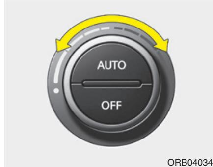
2. Gire el mando del control de la temperatura para fijar la temperatura deseada.
