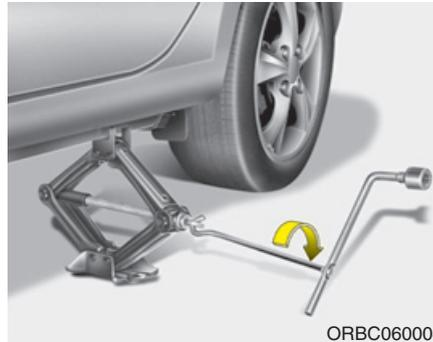
8. Introduzca la manivela en el gato y gírela en el sentido de las agujas del reloj, elevando el vehículo hasta que la rueda se separe del suelo. Esta distancia es de aproximadamente 30 mm (1,2 in.). Antes de sacar las tuercas de las ruedas, asegúrese de que el vehículo se mantiene estable y que no hay riesgo de que se mueva o se deslice.
