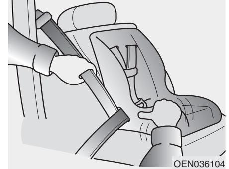
3. Enganche el cinturón de seguridad y deje que recupere la posible holgura. Una vez montado el sistema de sujeción, trate de moverlo en todas las direcciones para asegurarse de que está bien anclado.
