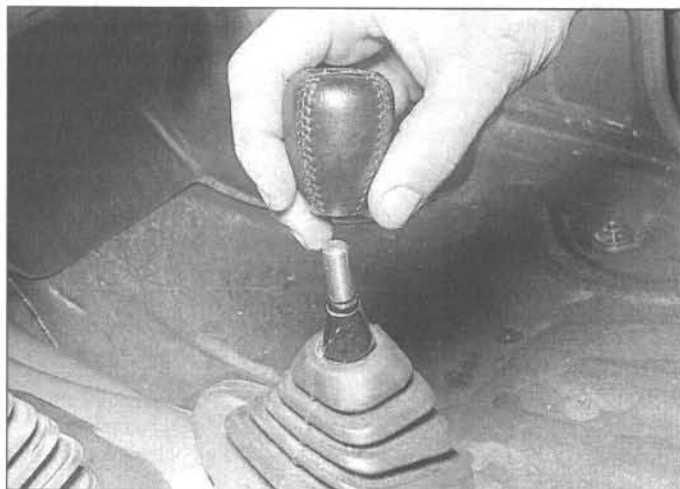
2.2a Unscrew the shift knob ...
