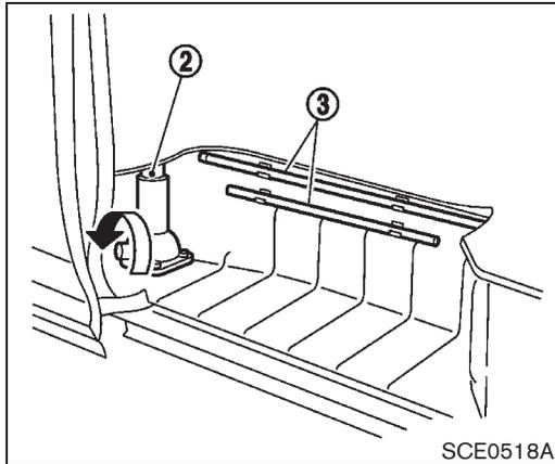
Retire el gato ② y las varillas del gato ③ del escalón de la puerta corrediza. Gire la palanca del gato tal como se indica en la ilustración para retirarlo.
