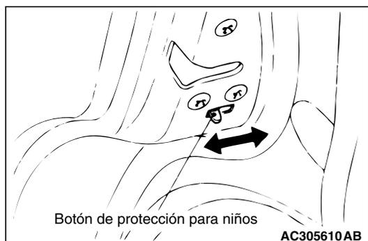
7. Compruebe que las puertas traseras no se pueden abrir con el tirador interior cuando el botón de protección para niños del extremo de la puerta se encuentra en la posición LOCK con el pistón de cierre interior elevado.
