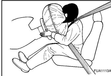
Ambos módulos de Airbag están ubicados en el centro del volante de dirección y frente al acompañante en el panel. Cuando el SRSCM detecta un impacto fuerte en la parte frontal del vehículo, automáticamente desplegará el Airbag.
