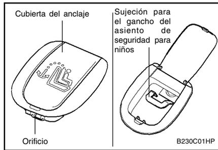
1. Abra la cubierta del anclaje situada en el suelo, detrás del asiento trasero, introduciendo la llave en el orificio.
