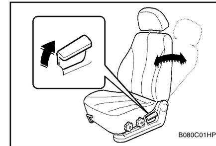
Para poder ajustar la inclinación del respaldo, usted debe inclinar su cuerpo ligeramente, de manera que el peso de la espalda no este contra el respaldo, en ese momento usted levanta la manilla que esta en la esquina del asiento, con la otra mano mueve el respaldo al ángulo deseado, luego para fijarlo, no tiene más que soltar la manilla.
