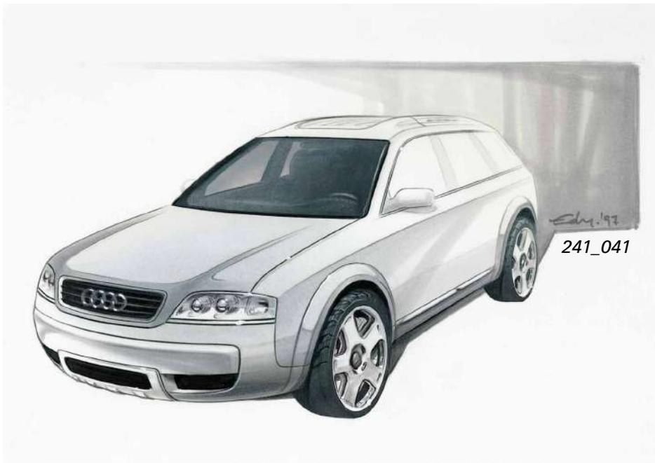
Con la probada tracción quattro, el tren de rodaje revisado y dotado de una "suspensión neumática de 4 niveles", la etapa reductora subsidiaria opcional "low range", así como con las modificaciones en la carrocería y el interior, el Audi allroad quattro combina dos categorías de vehículos que venían existiendo hasta ahora de forma separada, y ofrece así
