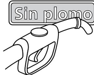
Su vehículo Ford está equipado con un catalizador y tiene una boca de carga del depósito de un diámetro menor que sólo permite usar las boquillas de los surtidores de combustible sin plomo.
