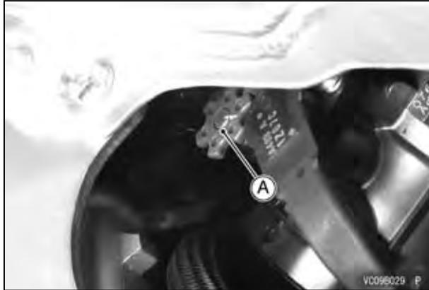
**A. Perilla del choke / tornillo de ajuste de ralentí.**
