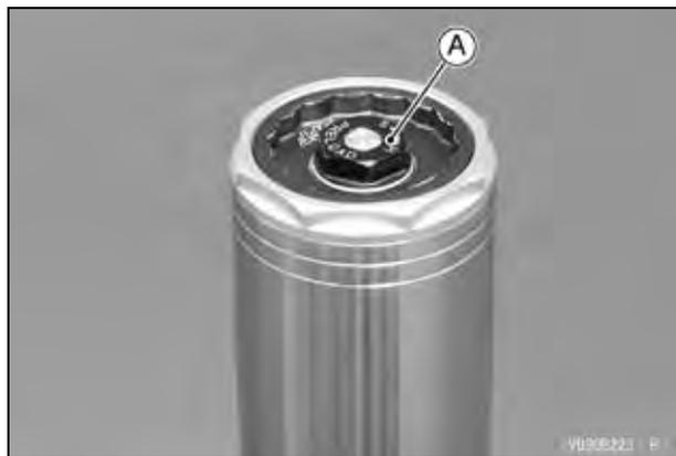
**A. Ajustador de precarga del resorte del amortiguador derecho**
