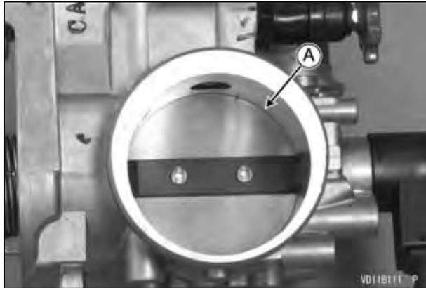
A. Superficie cilíndrica interna del acelerador
