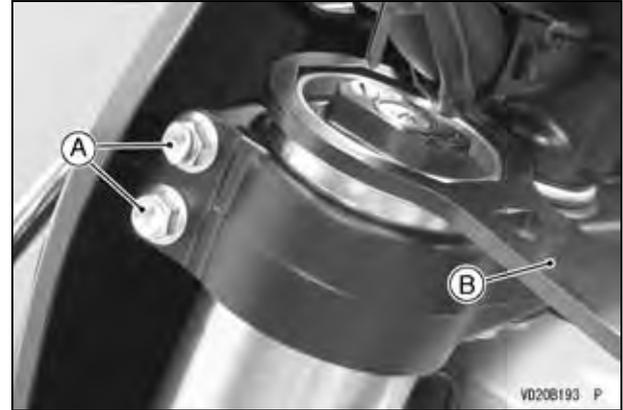
**A. Tornillos de las abrazaderas de la horquilla (superiores)**
