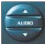
Efectúe impulsos sucesivos en la tecla "**AUDIO**" para acceder a los reglajes de los graves (**BASS**), de los agudos (**TREB**), del loudness (**LOUD**), del fader (**FAD**), del balance (**BAL**) y de la corrección automática del volumen (**CAV**).
