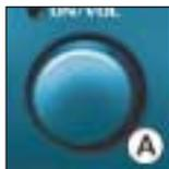
Con la llave de contacto en posición ACCESORIOS o CONTACTO, pulse el botón **A** para encender o apagar el autorradio.
