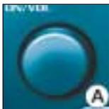
Con la llave de contacto en posición ACCESORIOS o CONTACTO, pulse el botón **A** para encender o apagar el aparato autorradio.
