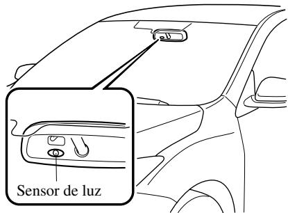
La función de atenuación automática se cancela cuando el encendido se encuentra en ON y la palanca selectora/ de cambios en la posición de marcha atrás (R).
