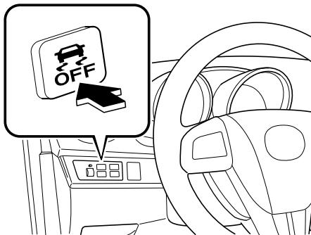
Oprima otra vez el interruptor para volver a encender el TCS/DSC. El indicador DSC OFF se apaga.
