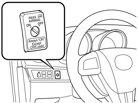
El interruptor de desactivación de la bolsa de aire del acompañante debe ser usado para desactivar la bolsa de aire del acompañante y las bolsas de aire laterales y también el sistema de pretensores del cinturón de seguridad del asiento del acompañante si se instala un sistema de seguridad para niños en el asiento del acompañante.
