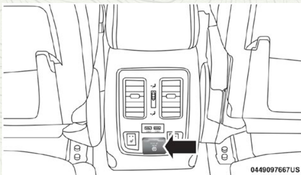
Inversor de corriente
