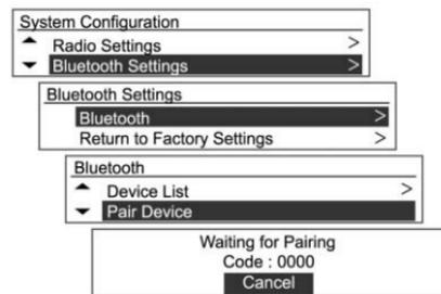
1. Presione **CONFIG**, y use **MENU/TUNE** para cambiar a Configuración de sistema → Ajustes Bluetooth → Bluetooth → Conectar dispositivo, y después presione **MENU/TUNE**.
