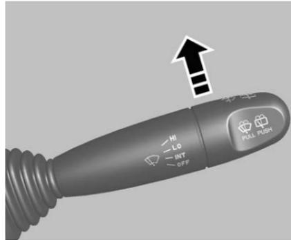
Para hacer funcionar los limpiaparabrisas, encienda la ignición y mueva la palanca de limpia/lavaparabrisas hacia arriba.
