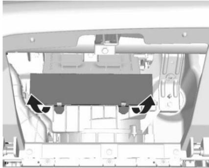
2. Retire la cubierta del filtro jalando la cubierta hacia arriba.
