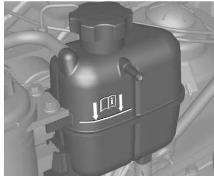
Si el sistema de enfriamiento está frío, el nivel del refrigerante debería estar arriba de la línea de la marca de llenado. Rellene si el nivel está bajo.
