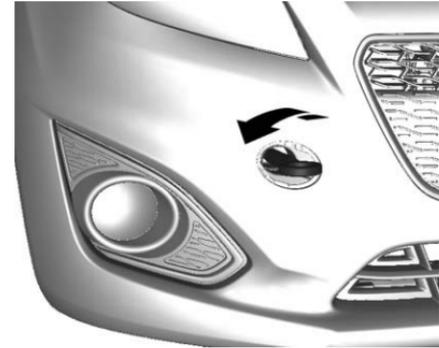
Atornille la argolla de remolque tanto como sea posible hasta que se detenga en una posición horizontal.
