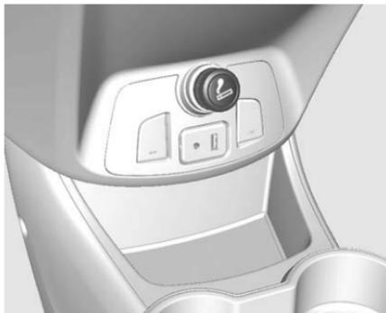
Para operar el encendedor de cigarrillos, gire el interruptor de ignición a ACC (accesorios) u ON (encendido) y oprima el encendedor completamente hacia adentro.
