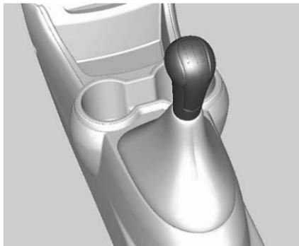
Reversa: con el vehículo detenido, presione el pedal del embrague y coloque la velocidad.
