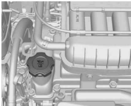
La tapa de relleno de aceite del motor está ubicado sobre la cubierta del árbol de levas.
