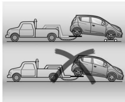
Si remolca por 2 ruedas, levante las ruedas de transmisión delanteras y remolque con las llantas delanteras aseguradas.
