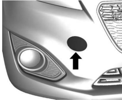
Desconecte la tapa en la parte inferior y retire hacia abajo.
