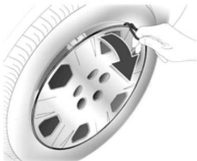
1. Retire las tapas de la tuerca de la rueda con un destornillador y retírela.
