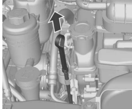
Cuando el nivel de aceite del motor haya caído a la marca MIN, rellene el aceite del motor.
