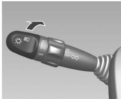
Para encender o apagar los faros delanteros y las luces traseras, gire el extremo de la palanca del interruptor de combinación.
