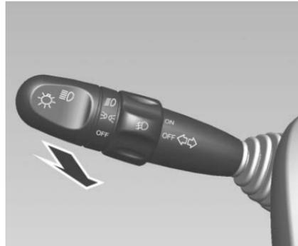
La palanca volverá a su posición normal al liberarla. Los faros de luces altas permanecen encendidos mientras usted retenga la palanca del interruptor de combinación hacia usted.
