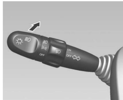
Para cambiar de luz baja a luz alta, empuje la palanca.
