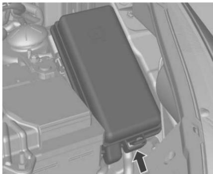
La caja de fusibles está en el compartimiento del motor.
