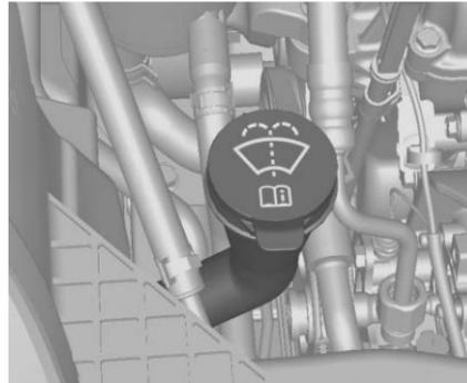
Rellene con agua limpia mezclada con una cantidad adecuada de fluido de lavador que contiene anticongelante. Para la relación de mezcla correcta consulte el contenedor de fluido del lavador.
