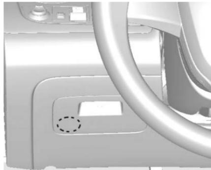
La caja de fusibles interior está ubicada en el lado inferior del tablero de instrumentos del lado del conductor.
