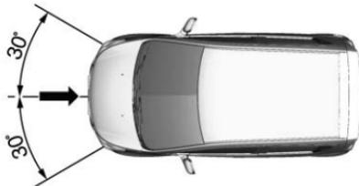
El sistema de bolsa de aire delantera se acciona en caso de un accidente de cierta gravedad en la zona descrita. La ignición debe estar encendida.
