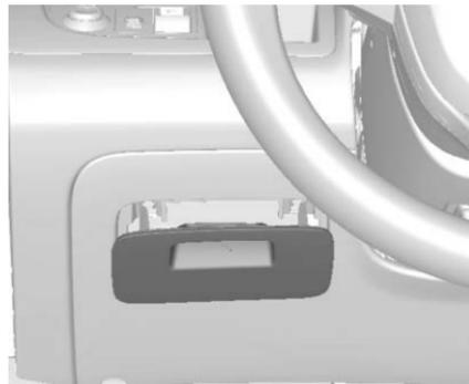
1. Abra la puerta del tablero de fusibles jalando hacia afuera en la parte superior.
