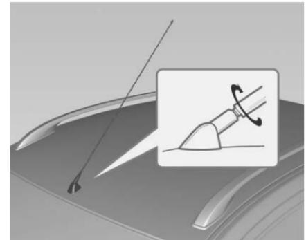
Para retirar la antena del techo, gírela en sentido contrario a las manecillas del reloj.
