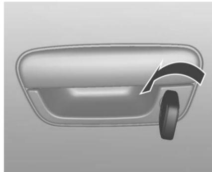
Desbloquee manualmente la puerta del conductor girando la llave en el seguro.
