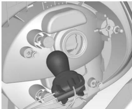
5. Retire el soporte del foco. Empuje el foco dentro del enchufe ligeramente, gírelo en sentido contrario a las manecillas del reloj, retírelo y reemplace el foco.
