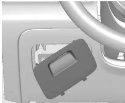
2. Retire la puerta del tablero de fusibles en diagonal.
