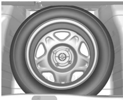
La rueda de refacción está ubicada en el compartimento de carga debajo de la cubierta del piso. Está asegurada en el hueco con una tuerca de mariposa.
