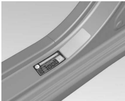
*Presión de llantas* ⇨ 176 y en la etiqueta en el marco de la puerta del conductor.
