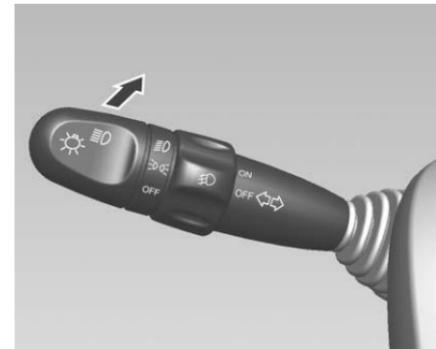
Para cambiar de luces bajas a altas, empuje la palanca.
