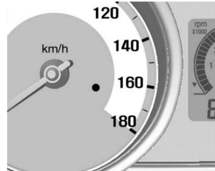
El indicador de seguridad parpadeará para indicar que el sistema anti-robo está funcionando.
