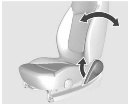
Jale la palanca, ajuste la inclinación y libere la palanca. Permita que el asiento se conecte audiblemente.
