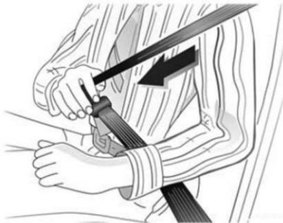
Extraiga el cinturón del retractor, guíelo sin retorcer de un extremo al otro del cuerpo e inserte la placa de seguro en la hebilla.
