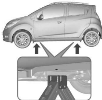
3. Gire la manija del gato para levantar la cabeza de levantamiento ligeramente y colocar el gato verticalmente en la posición marcada con el medio círculo.
