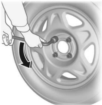
2. Despliegue la llave de la rueda e instálela asegurando que se ubique firmemente y afloje cada tuerca de rueda media vuelta.
