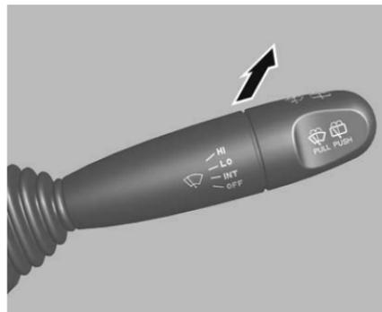
Para operar el limpiador o lavador trasero, empuje la palanca hacia el tablero de instrumentos. Oprima una vez: el limpiador operará continuamente en baja velocidad. Para rociar fluido de lavador, oprima la palanca una vez más.
