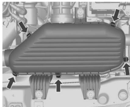
1. Afloje los sujetadores de conexión de la cubierta del filtro de aire y abra la cubierta.
