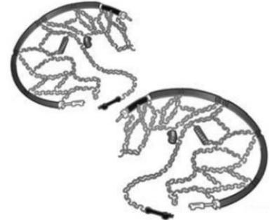
Sólo se permiten cadenas para llantas en las ruedas delanteras.
