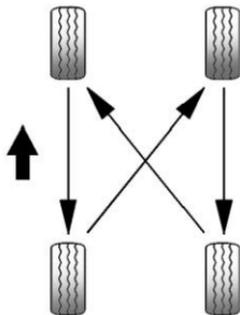
Al hacer la rotación de las llantas, siga siempre el patrón de rotación correcto ilustrado aquí. No incluya la llanta de refacción en la rotación de las llantas. Ajuste las llantas delanteras y traseras a la presión de inflado recomendada en la etiqueta de información de llanta y carga después que se hayan rotado las llantas.
