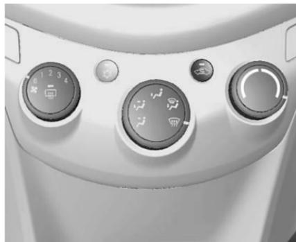
1. Gire la perilla de distribución de aire a DEFROST
