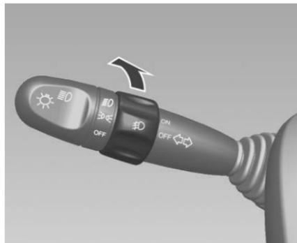
Para encender las luces anti-niebla, asegúrese que los faros de luces bajas estén encendidas.
