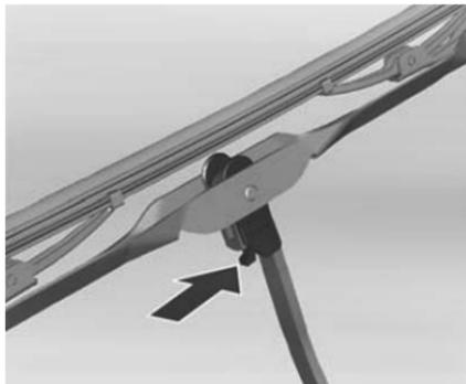
Levante el brazo del limpiador. Presione la palanca de liberación y desconecte el aspa del limpiador.
