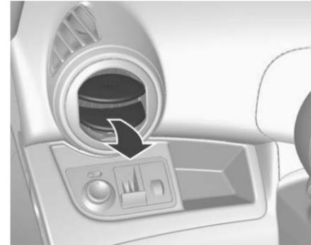
Presione la cubierta de cada salida de aire para abrir las ventilas laterales, y gire a la dirección que desee.
