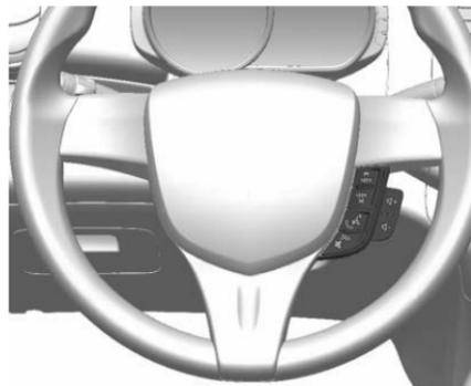
El sistema de infoentretenimiento se puede operar por medio de los controles del volante.
