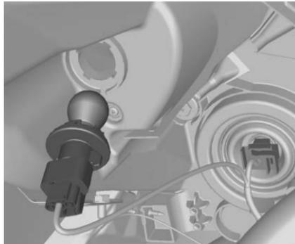
2. Empuje el foco dentro del enchufe ligeramente, gírelo en sentido contrario a las manecillas del reloj, retírelo y reemplace el foco.
