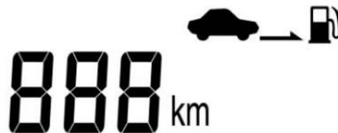
Este modo indica la distancia de conducción calculada para vaciarse a partir del combustible actual en el tanque de combustible.
