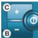
Efectúe impulsos sucesivos en la tecla **C** para aumentar el volumen sonoro del autorradio o en la tecla **B** para disminuirlo.
