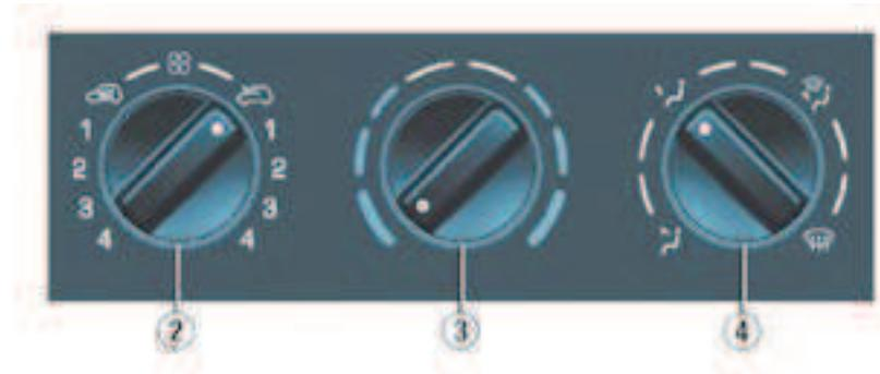
**El aire acondicionado no funciona cuando el mando de reglaje de caudal de aire está en la posición mínimo.**
