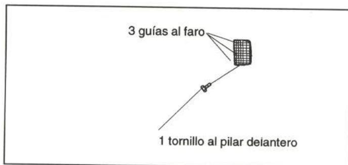
**Figura 16.-** Unión del piloto delantero
