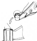
Recorte del collarín del silentbloc trasero 1. Parte a recortar.
