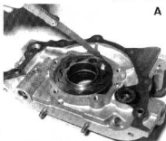
Control de los juegos de bomba de aceite A. Radial - B. Axial.
