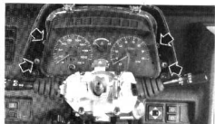
Tornillos de fijación del cuadro de instrumentos.
