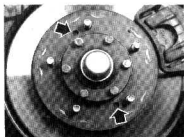
Taladros roscados M8 x 1,25 que permiten extraer el disco.
