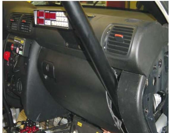
Se deben modificar las guanteras derecha e izquierda para permitir el paso de la barra vertical del arco de seguridad.
