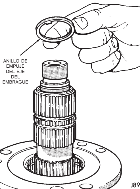
Fig. 75 Instalación de arandela de empuje del eje del embrague
