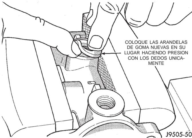
Fig. 45 Instalación de arandelas
