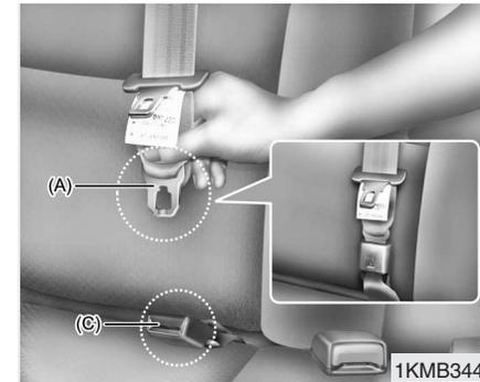
2. Introduzca la placa de la lengüeta (A) en el extremo abierto de la hebilla (C) hasta escuchar el chasquido que indica que el cinturón está sujeto en la hebilla. Asegúrese de que el cinturón no está retorcido.
