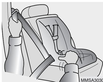
4. Enganche el cinturón de seguridad y deje que recupere la posible holgura. Una vez montado el sistema de sujeción, trate de moverlo en todas las direcciones para asegurarse de que está bien anclado.
