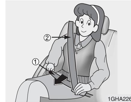
4. Colóquese la parte abdominal (①) del cinturón cruzando el abdomen, **TAN BAJO SOBRE LAS CADERAS** como pueda, a fin de reducir el riesgo de deslizarse por debajo en caso de accidente. Ajuste el cinturón de forma que esté **BIEN CENIDO**, tirando de la parte de bandolera (②). El retractor del cinturón recogerá lo que sobre y mantendrá la tensión del cinturón. Para su seguridad, no deje flojo el cinturón.
