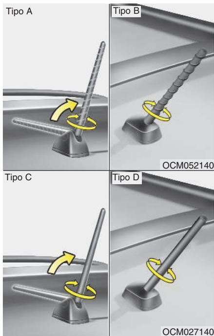
Se puede ajustar esa antena hacia arriba o hacia abajo, o desmontarla cuando se lava el vehículo.
