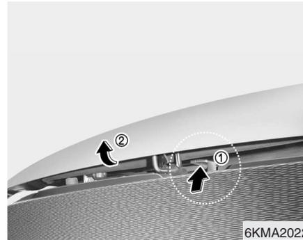
2. Vaya a la parte delantera del vehículo, levante ligeramente el capó, empuje el pestillo secundario (1) que hay en el interior de la parte central y continúe levantando (2) el capó.
