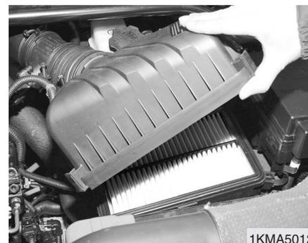
2. Limpie el interior de la carcasa del filtro de aire con un trapo limpio y húmedo.
