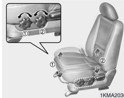
**Ajuste de la altura del asiento (del conductor)**
