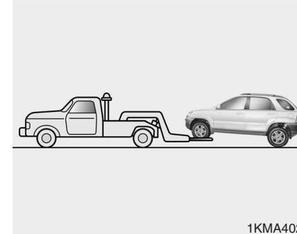
Los vehículos con tracción a dos ruedas se pueden remolcar con las ruedas traseras apoyadas en el suelo y las delanteras levantadas.
