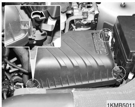
1. Suelte los enganches de la tapa del filtro de aire y levántela.
