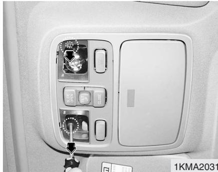
2. Retire los dos (2) tornillos, y a continuación la consola que está sobre el parabrisas.
