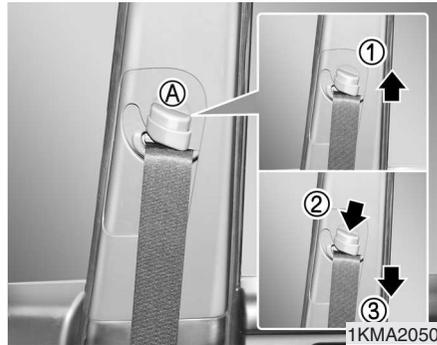
5. Ajuste la altura del anclaje de la zona del hombro a su tamaño. Para subir la posición del anclaje, empújelo hacia arriba (1). Para bajar la posición de anclaje, apriete (2) el botón (A) y deslícelo hacia abajo (3). Una vez efectuado el ajuste, asegúrese de que el anclaje ha quedado fijo en su sitio.
