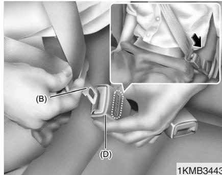
3. Tire de la placa de la lengüeta (B) e introdúzcala en el extremo abierto de la hebilla (D) hasta escuchar el chasquido que indica que el cinturón está sujeto en la hebilla. Asegúrese de que el cinturón no está retorcido.
