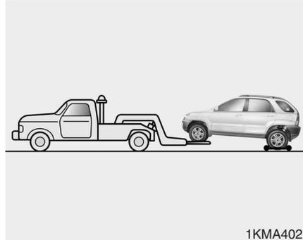
Los vehículos de tracción a las cuatro ruedas hay que remolcarlos con un elevador de ruedas o con una plataforma, de modo que todas las ruedas queden en el aire.
