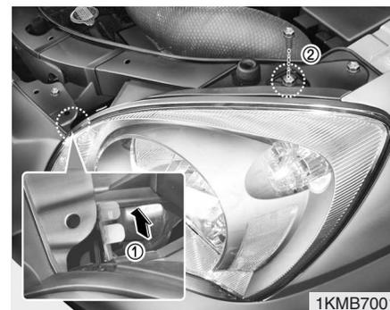
3. Retirar el pasador (1) y aflojar los tornillos de sujeción (2).
