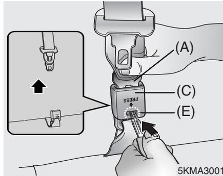
2. Para recoger el cinturón trasero central, inserte la llave ó un objeto rígido similar en el botón de liberación (E) dispuesto en el conector de anclaje. Tirar hacia arriba del cinturón de seguridad (A) permitiendo así que la cinta se enrolle automáticamente.
