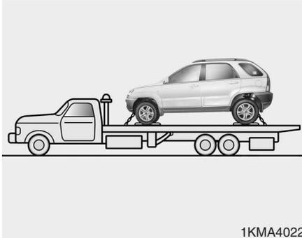
Si tiene que remolcar el vehículo, acuda a un distribuidor autorizado Kia o a una empresa con un servicio de grúa adecuado. Es necesario seguir un procedimiento adecuado para levantar y remolcar el vehículo sin dañarlo. Se recomienda usar carritos de transporte para las ruedas o un camión con plataforma.
