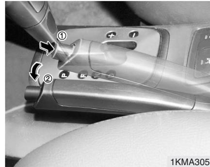
Para soltar el freno de estacionamiento, tire ligeramente hacia arriba de la palanca y apriete el botón de liberación; a continuación baje la palanca a la posición de freno suelto mientras mantiene apretado el botón.
