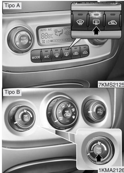
El dispositivo de deshielo calienta el cristal para eliminar el hielo, el vaho o la escarcha del interior o el exterior de la luneta trasera, siempre que funcione el motor.
