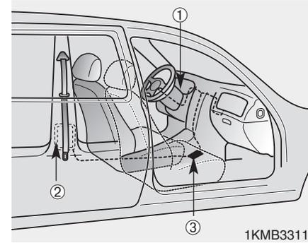
El sistema pretensor del cinturón de seguridad consta de los siguientes componentes principales. En la ilustración se muestra su situación.
