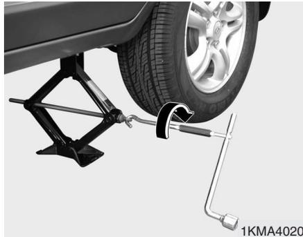
8. Introduzca la manivela en el gato y gírela en el sentido de las agujas del reloj, elevando el vehículo hasta que la rueda deje de tocar el suelo (deben quedar unos 30 mm entre el neumático y el suelo). Antes de sacar las tuercas de la rueda, asegúrese de que el vehículo se mantiene estable, sin riesgo de movimiento o deslizamiento.
