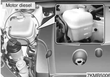
Compruebe el estado y las conexiones de todos los manguitos del sistema de refrigeración y calefacción. Sustituya los que estén deteriorados.
