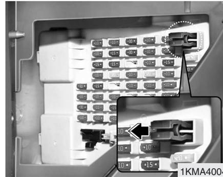
3. Compruebe el estado del fusible extraído y sustitúyalo si está fundido. Utilice el extractor que se encuentra en la caja de fusibles.
