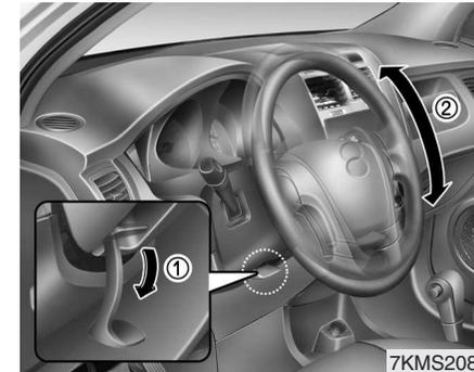
Para cambiar el ángulo de inclinación del volante, tire hacia abajo de la palanca de bloqueo (①), ajuste el volante al ángulo deseado (②) y tire hacia arriba de la palanca para bloquearlo en la nueva posición.
