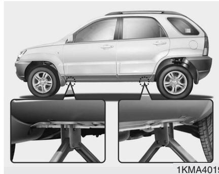
7. Coloque el gato en la posición delantera o trasera más cercana a la rueda que vaya a cambiar. Engánchelo en los apoyos previstos en los bajos del vehículo. Estos apoyos son unas placas soldadas a la chapa con dos pestañas y un punto de fijación donde debe colocarse el gato.
