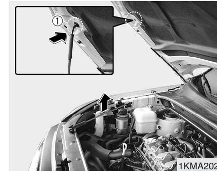
3. Levante el capó y sosténgalo abierto con la barra de apoyo, introduciendo su extremo libre en la ranura correspondiente (1).
