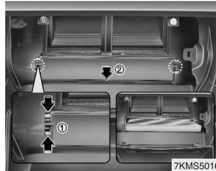
3. Retire la tapa del filtro del acondicionador de aire apretando las pinzas que hay a ambos lados de la tapa.
