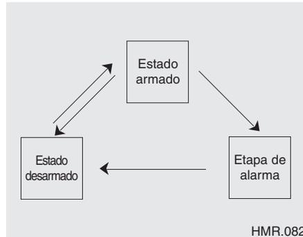
Este sistema está diseñado para proteger frente a la entrada no autorizada al vehículo. Funciona en tres etapas: la primera es "Armado", la segunda "Alarma" y la tercera "Desarmado". Cuando se activa, el sistema proporciona una alarma acústica y enciende los intermitentes de emergencia.
