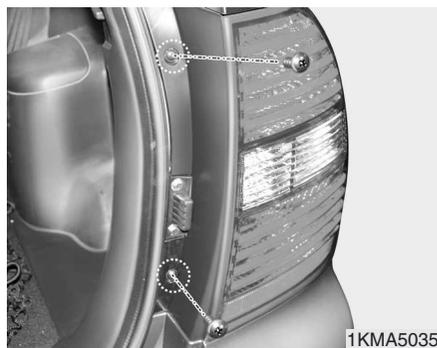
2. Afloje los tornillos del conjunto luminoso con un destornillador de punta Phillips.
