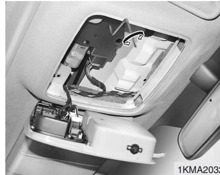
3. Inserte la manivela de emergencia (que se entrega con el vehículo) y gírela en el sentido de las agujas del reloj para abrirlo o en sentido contrario para cerrarlo.
