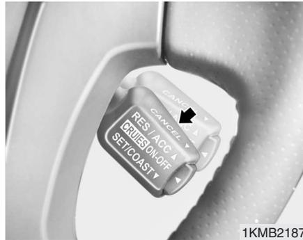
3. Empuje hacia abajo el interruptor SET/COAST, y suéltelo cuando el vehículo marche a la velocidad que desee. Se encenderá la luz indicadora "SET" del panel de instrumentos. Suelte el acelerador al mismo tiempo. La velocidad deseada se mantendrá constante de forma automática.
