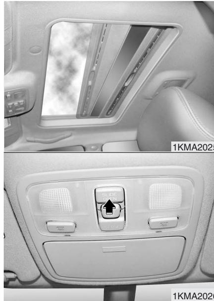
**Deslizamiento del techo solar**
