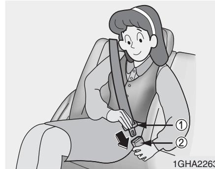
3. Introduzca la placa de la lengüeta (①) en el extremo abierto de la hebilla (②) hasta escuchar el chasquido que indica que el cinturón está sujeto en la hebilla.
