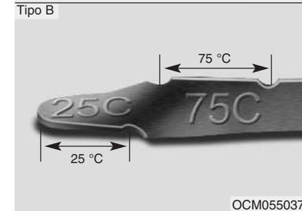
3. Compruebe que el nivel de líquido está en el margen "HOT/75 °C" en el indicador de nivel. Si el líquido es inferior, añada el líquido específico por el orificio del llenado. Si el líquido es superior, drene el líquido específico por el orificio del drenaje.
