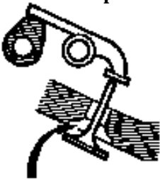
Válvula de escape a poner en plena apertura
