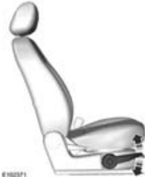
Jale la palanca lateral hacia arriba para elevar el cojín del asiento del conductor.
