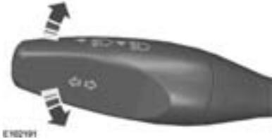
Si la palanca se mueve hacia arriba o hacia abajo, las luces direccionales destellarán tres veces. Véase Luces direccionales (página 35).
