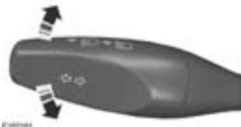
Mueva la palanca hacia arriba/abajo para activar las luces direccionales hacia la derecha o hacia la izquierda respectivamente.
