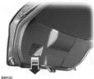
Se ha moldeado una cavidad en el panel interior de la compuerta trasera para jalarla y facilitar su cierre.
