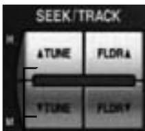
Al presionar el botón *TUNE ▲▼* durante menos de 1.5 segundos se activa la función del modo *SINTONIZAR ARRIBA/ABAJO*. Al presionar el botón *TUNE ▲▼* durante más de 1.5 segundos se activa la función del modo *BÚSQUEDA ARRIBA/ABAJO*.
