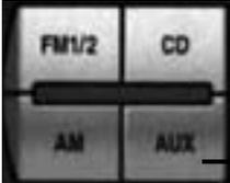
Al presionar el botón **"AUX"** se activa el modo **"AUX"**, que permite reproducir una función de entrada externa de audio (únicamente fuentes de audio).
