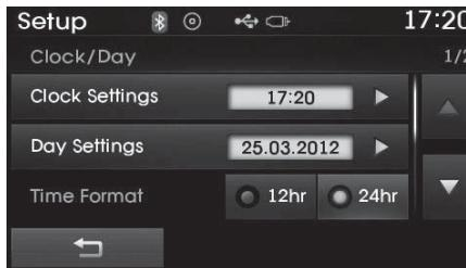
Esta función sirve para cambiar el formato del reloj entre 12h y 24h.
