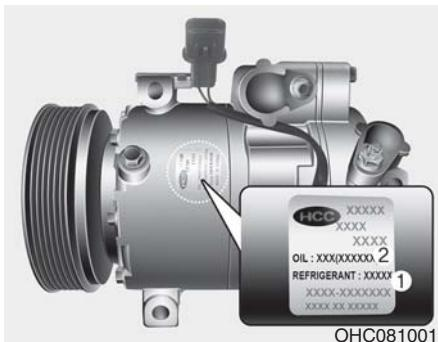
Una etiqueta del compresor le informa del tipo del compresor del vehículo. En esta se incluye el modelo, el número de pieza del suministrador, el número de producción, refrigerante (1) y aceite refrigerante (2).
