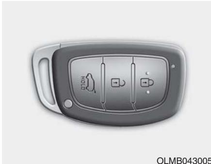
Si tiene una llave smart, puede bloquear y desbloquear una puerta (y el portón trasero) e incluso arrancar el motor sin meter la llave.
