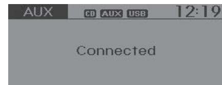
\* El modo AUX no puede activarse a menos que haya conectado un dispositivo externo al terminal AUX.
