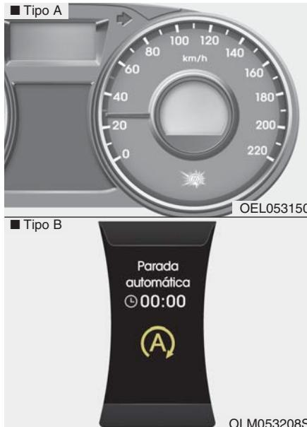
El motor se parará y el indicador verde de PARADA AUTOMÁTICA (A) se encenderá en el tablero de instrumentos. Si su vehículo está equipado con un tablero de instrumentos de supervisión, el aviso se iluminará en la pantalla LCD.
