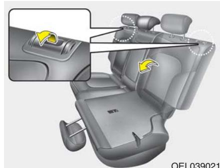
4. Tire de la palanca de plegado del respaldo y pliegue el asiento hacia adelante.
