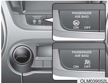
**Para desactivar o volver a activar al airbag del acompañante:**
