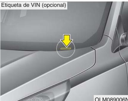
El VIN está también colocado en la placa de la parte superior del salpicadero. El número de la placa se puede ver fácilmente a través del parabrisas exterior.
