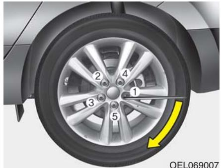
Coloque después la llave como se muestra en la figura y apriete las tuercas de la rueda. Asegúrese de que la cazoleta asienta completamente sobre la tuerca. No se ponga de pie sobre la llave ni utilice un tubo para prolongar el brazo de palanca.
