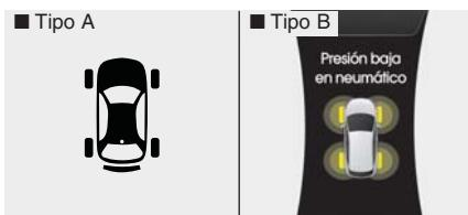
Cuando se iluminan los indicadores del sistema de control de la presión de los neumáticos, uno o más de los neumáticos está por debajo de la presión adecuada. El dispositivo avisador de posición de la presión baja de los neumáticos indicará si un neumático está por debajo de la presión de inflado correcta al iluminar la luz de posición correspondiente.
