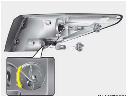
4. Retire el casquillo del conjunto de las luces haciendo girar en sentido contrario a las agujas del reloj hasta que sus patillas queden alineadas con las ranuras del conjunto.
