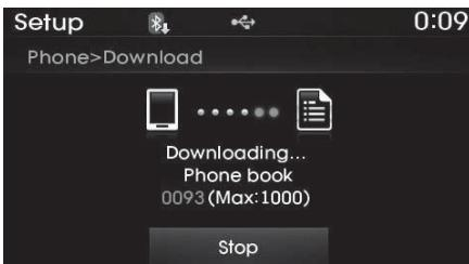
El listín de teléfonos se descarga del teléfono móvil y se visualiza el proceso de descarga.
