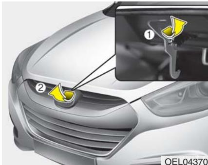
2. Vaya a la parte delantera del vehículo, levante ligeramente el capó, tire del pestillo secundario (1) que hay en el interior de la parte central y continúe levantando el capó (2).
