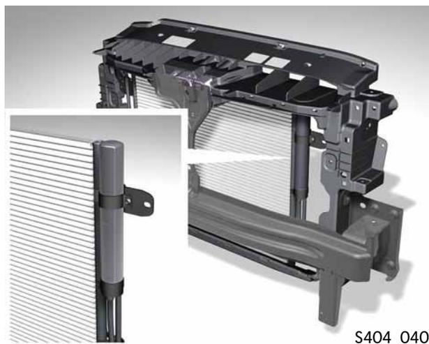
En el Tiguan se han realizado diversas mejoras por lo que respecta al condensador con deshidratador integrado. La botella deshidratadora del condensador se ha recortado para conseguir un mejor comportamiento de cara a una eventual colisión.
