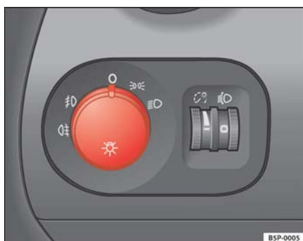
Fig. 69 Detalle del tablero de instrumentos: mando de las luces, faros antiniebla y luz trasera antiniebla
