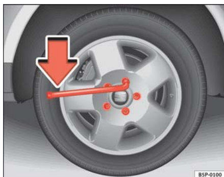
Fig. 158 Cambio de rueda: aflojar los tornillos de rueda
