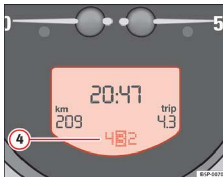
Fig. 38 Detalle del cuadro de instrumentos: pantalla con indicador de marchas del Tiptronic
