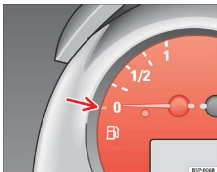
Fig. 35 Cuadro de instrumentos: indicador de nivel del depósito de combustible
