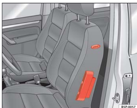
Fig. 22 Airbag lateral en el asiento del conductor
