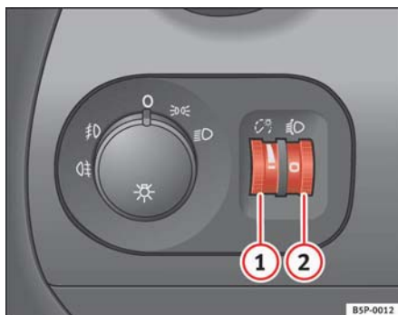
Fig. 70 Tablero de instrumentos: reguladores de la iluminación de instrumentos y mandos y del alcance de los faros
