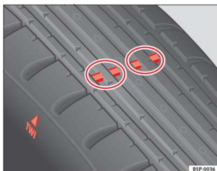
Fig. 152 Indicadores de desgaste del perfil del neumático
