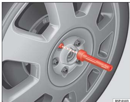
Fig. 161 Cambio de rueda: Útil de hexágono interior para girar los tornillos
