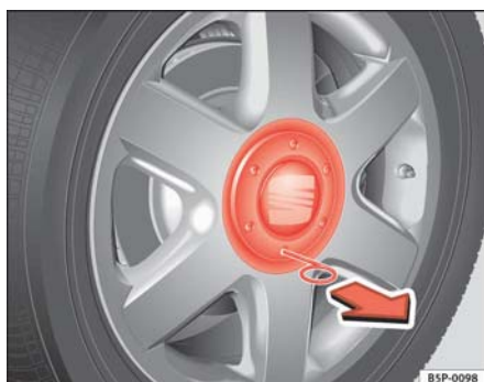
Fig. 157 Cambio de rueda: Retirar el embellecedor de la rueda
