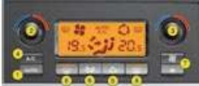
Este sistema regula automáticamente la temperatura, el caudal de aire y la repartición de aire en el habitáculo en función de si ha elegido caliente o frío (en cada uno de los lados, derecho o izquierdo).
