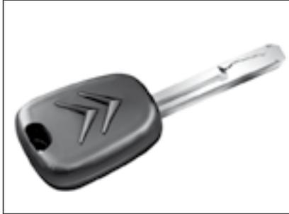
La llave permite bloquear y desbloquear todas las cerraduras del vehículo y poner el motor en marcha.
