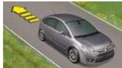
En pendiente descendente, vehículo parado y marcha atrás introducida, el vehículo queda frenado un instante al soltar el pedal de freno.
