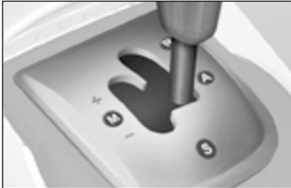
Un **modo automatizado** con la palanca de velocidades en posición **A**.
