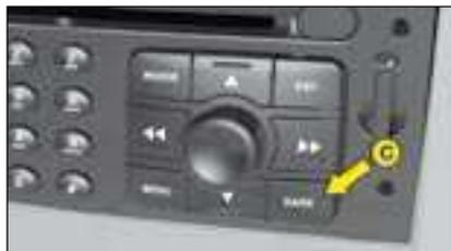
Después de un primer apoyo sobre el mando **C**, sólo la parte superior de la pantalla permanece encendida.
