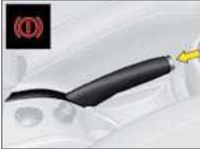
El freno de estacionamiento se acciona, con el vehículo parado, tirando de la palanca con más energía cuando mayor es la pendiente.
