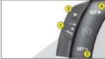
Este dispositivo de ayuda a la conducción le permite seleccionar la velocidad máxima que usted no desea sobrepasar. Esta deberá ser superior a 30 km/h.
