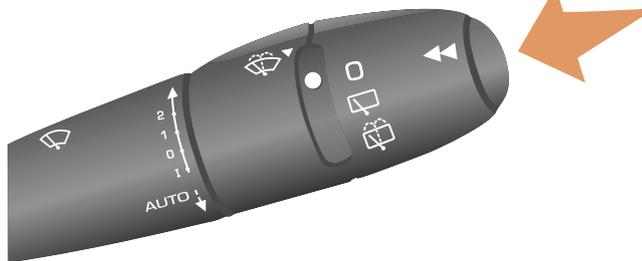
Cada impulso en el botón, situado en el extremo del **mando del limpiaparabrisas**, permite señalar sucesivamente los diferentes datos del ordenador de a bordo, en función de la pantalla.
