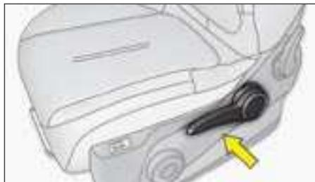
Altura e inclinación del cojín del asiento conductor
