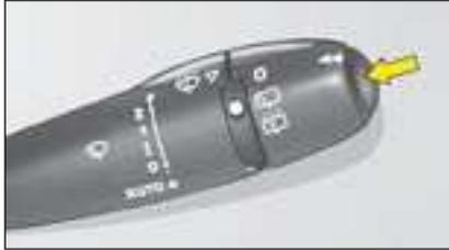
Para visualizar y seleccionar diferentes informaciones, efectuar breves impulsos sobre el extremo del mando limpiaparabrisas delantero.
