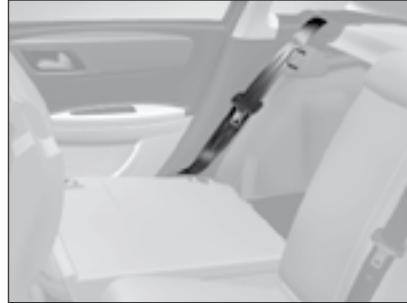
Al manipular los asientos traseros, procure no pillar los cinturones y posicione correctamente las hebillas de bloqueo de los cinturones de seguridad.
