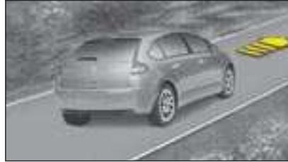
En pendiente de subida, con el vehículo parado, este es mantenido un corto instante al soltar el pedal de freno, si usted ha seleccionado **A** o **M**.
