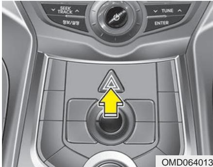
Las luces de emergencia sirven para avisar a los demás conductores que extremen las precauciones cuando se aproximen o adelanten su vehículo.
