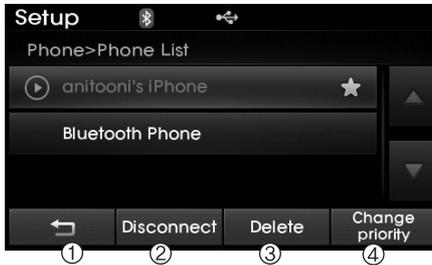
Esta función sirve para ver los teléfonos móviles que se han configurado al sistema de audio. Al seleccionar un teléfono configurado, se visualiza el menú de ajuste.
