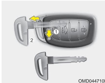
Pulse y mantenga pulsado el botón de liberación (1) y extraiga la llave mecánica (2). Introduzca la llave mecánica en el orificio para la llave en la puerta.
