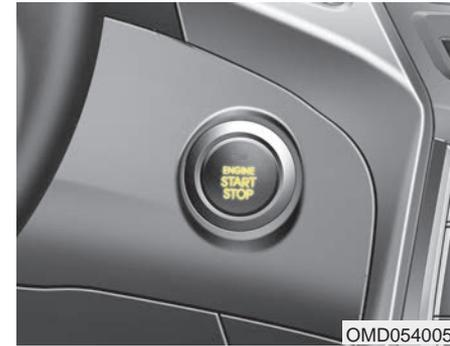
Cuando la puerta delantera está abierta, el botón de inicio/parada del motor se ilumina, y se apaga 30 segundos después de cerrar la puerta.
