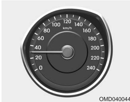
El velocímetro indica la velocidad del vehículo y está calibrado a kilómetros por hora (km/h) y/o millas por hora (mph).
