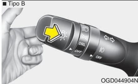
Para hacer ráfagas con las luces de carretera, tire de la palanca hacia usted y suéltela. Las luces de carretera se encenderán durante el tiempo que mantenga la palanca sujeta hacia usted.
