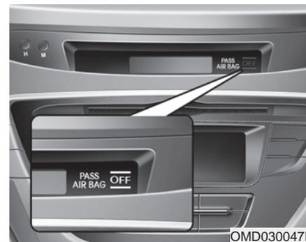
Su vehículo está equipado con un sistema de clasificación del ocupante del asiento (OCS) del acompañante delantero. El OCS ha sido concebido para detectar la presencia de un pasajero delantero correctamente sentado y determinar si debe activar (permitir el inflado) o no el airbag del acompañante. El airbag delantero del conductor no queda afectado ni controlado por el OCS.
