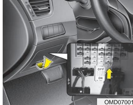
Coloque siempre el interruptor del fusible en la posición ON.
