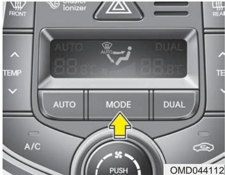
El botón de selección de modo controla la dirección de flujo del aire a través del sistema de ventilación.
