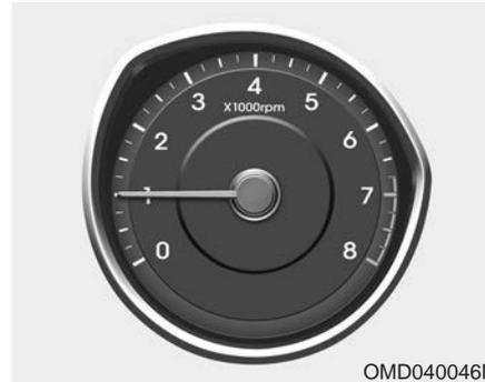
El tacómetro indica el número aproximado de las revoluciones del motor por minuto (rpm).
