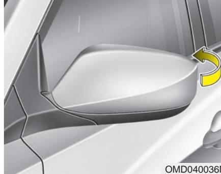
Para plegar el retrovisor exterior, sujete la carcasa del retrovisor y después plieguelo hacia la parte trasera del vehículo.
