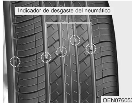
Si el neumático está desgastado de manera uniforme, el indicador del desgaste de la banda de rodadura aparecerá como una banda sólida a lo largo de la banda de rodadura. Esto indica que la banda de rodadura en el neumático es inferior a 1,6 mm (1/16 pulgadas). Reemplace el neumático cuando esto ocurra.
