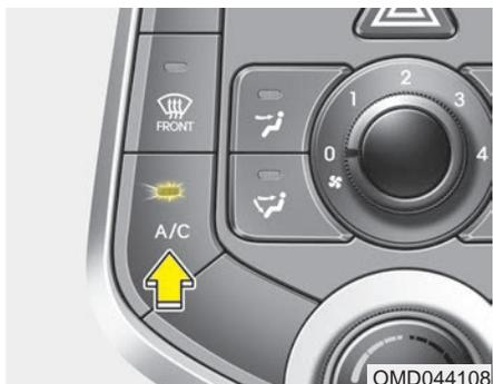
Pulse el botón A/C para encender el sistema de aire acondicionado (se iluminará un testigo indicador). Pulse el botón otra vez para apagar el aire acondicionado.
