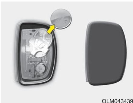
Si la llave inteligente no funciona correctamente, intente cambiar la pila por una nueva.
