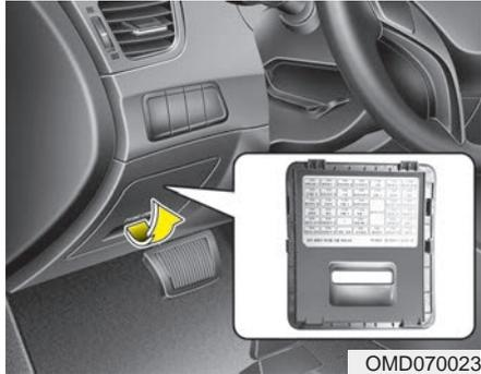
En la parte interior de la cubierta del panel de fusibles/relés, encontrará la etiqueta de los fusibles y relés que describe el nombre y la capacidad de los mismos.
