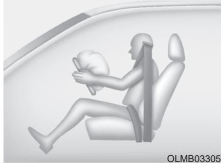
Cuando el SRSCM detecta un impacto fuerte en la parte delantera del vehículo, se desplegarán automáticamente los airbags delanteros.
