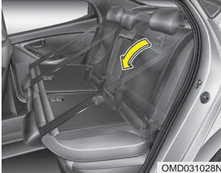
4. Pliegue el respaldo del asiento hacia la parte delantera del vehículo.
