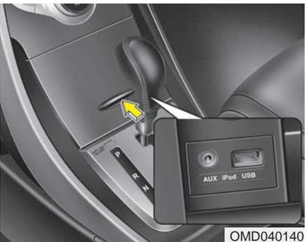
Si su vehículo tiene un puerto AUX y/o USB (bus serial universal), puede usar el puerto AUX para conectar los dispositivos de audio y el puerto USB para enchufar un dispositivo USB e iPod.
