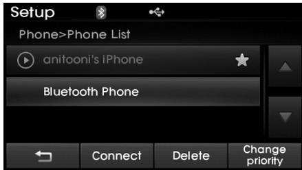
En la lista de teléfonos configurados, seleccione el dispositivo actualmente conectado y pulse el botón **Disconnect**.
