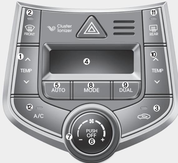
1. Botón de control de la temperatura del conductor
