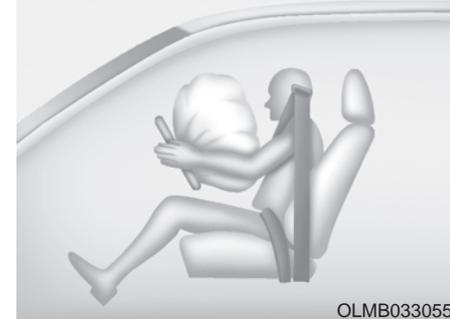
Una vez desplegado, las costuras moldeadas directamente en las cubiertas del panel se separarán por la presión de la expansión del airbag. Esta mayor apertura de las cubiertas es lo que permite el completo inflado de los airbags.
