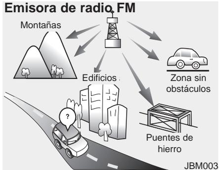
Las emisoras FM se transmiten a altas frecuencia y no toman la curva de la superficie de la tierra. Debido a ello, las emisoras FM suelen empezar a perder intensidad a cortas distancia de la estación. Asimismo, las construcciones, montañas u otros obstáculos afectan de manera más fácil las señales FM. Ello afecta negativamente a las condiciones de escucha y le haría creer que su radio tiene problemas. Las siguientes condiciones son normales y no indican un problema de la radio:
