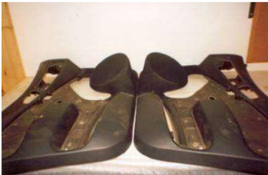
y le damos la primera mano de resina, de manta de fibra de vidrio y varias capas mas para endurecer la moldura a tal extremo que no vibre con los golpes del woofer
