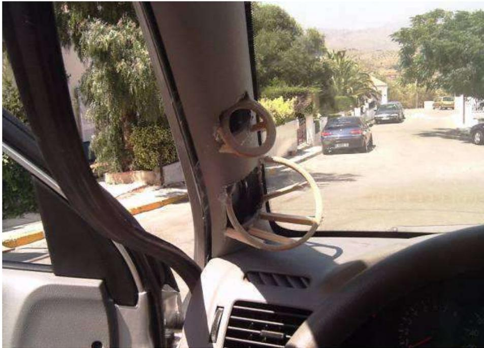
comprobada su orientación y su buen resultado auditivo, le colocamos la tela de licra y procedemos a pintarlo con resina de poliéster y reforzando debajo del 4" con manta de fibra de vidrio.
