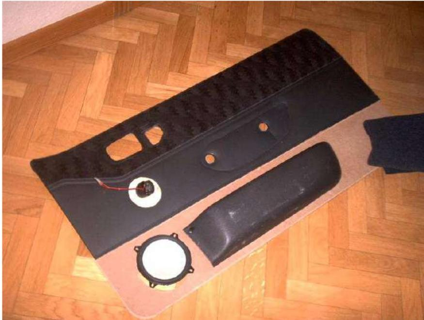
Después y una vez comprobado que todo encaja adecuadamente tapizaremos la puerta, en mi caso lo hice con cola y grapas por la parte posterior. Dejaremos que sobre moqueta por la parte de arriba para montar el panel superior encima del otro para disimular si hay alguna irregularidad.
