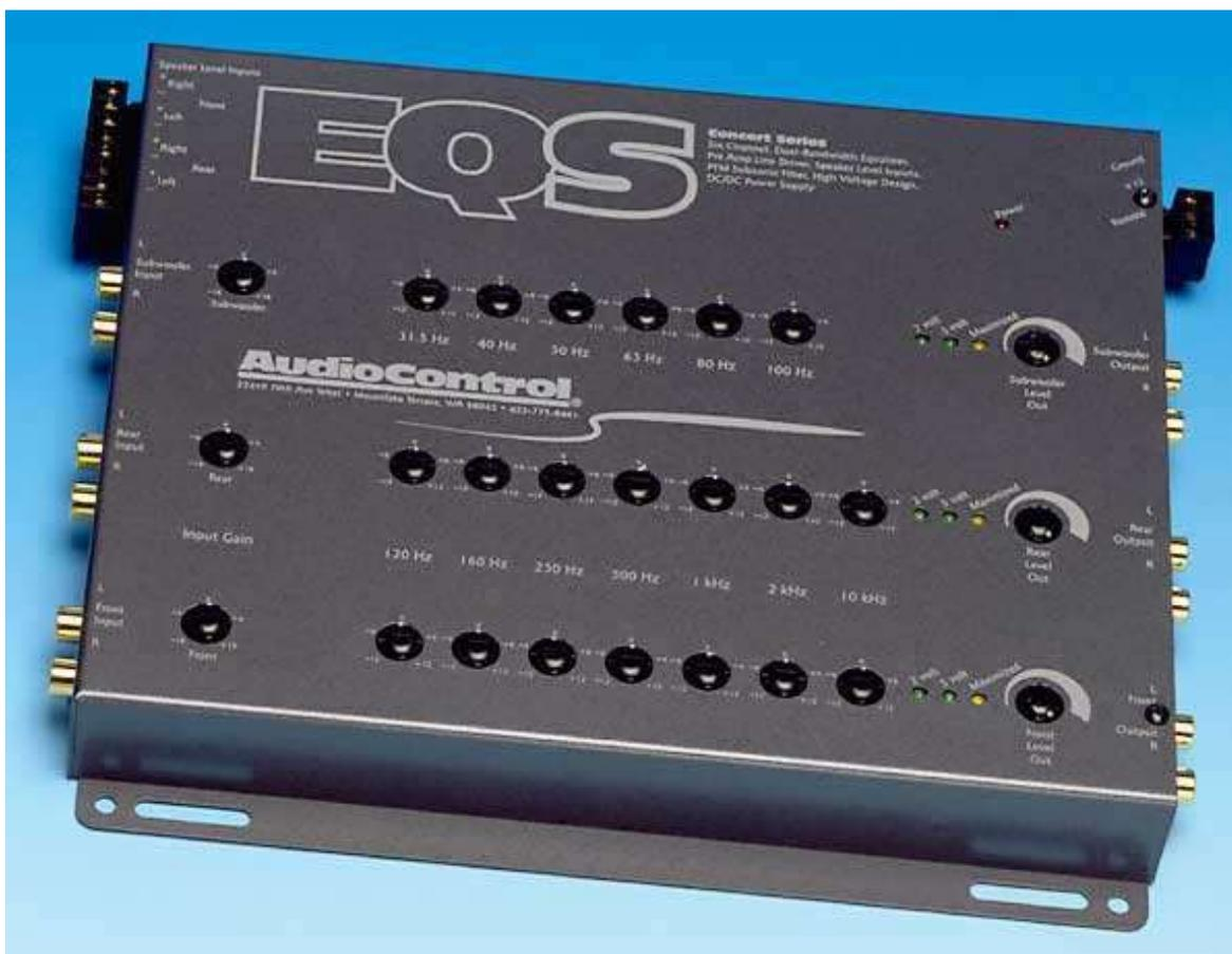
Las salidas de señal de audio de tu ecualizador, irán conectadas a las entradas de audio de tu/s amplificador/es.
