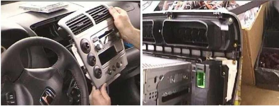
Se procede a desatornillar el estereo del tablero, que regularmente vienen atados a éste.
