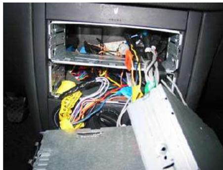
Una vez conectado todo, procedemos a insertar el estereo en el tablero y a conectar nuestra batería para hacer la prueba de sonido.
