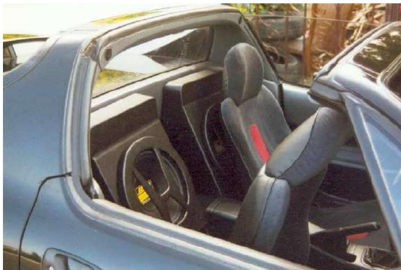
Pues manos a la obra, al igual que los otros montajes se inicia con la fabricación con DM del aro que soportara el sub, en este caso se fabrico con DM de 5mm, aunque parezca muy endeble para un 12" , aquí solo sirve para dar la forma a la tela, el que soportara el altavoz será las capas de fibra de vidrio que le pongamos.
