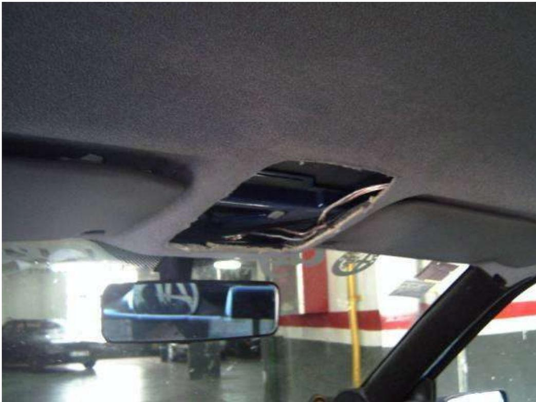
Desmontamos el soporte de las luces y desmontamos todos los plásticos para quedarnos con la estructura que soporta estos mecanismos
