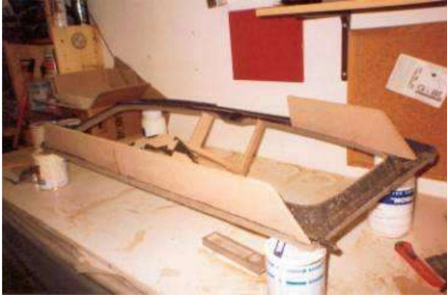
construida la parte baja pondremos la tela de licra por encima y colocaremos el segundo aro definitivo para sujetar el altavoz.
