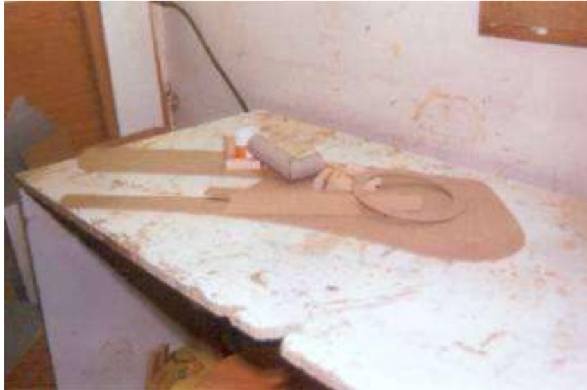
el siguiente paso será ubicar el 6", ,para ello se corta un aro de madera de 4mm de grosor, con las medidas adecuadas al woofer que montamos, este aro se monta sobre unos tacos de madera de 25mmx25mm y con el largo adecuado para que el imán del altavoz no toque la madera, según fotografías siguientes
