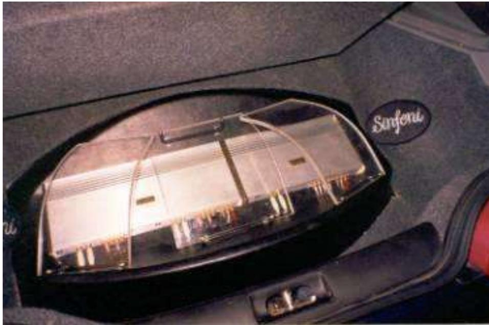
para finalizar se le montan a los metacrilatos unos trozos de papel adhesivo mate para que no se vean los cables ni los soportes del metacrilato, y faena finalizada.
