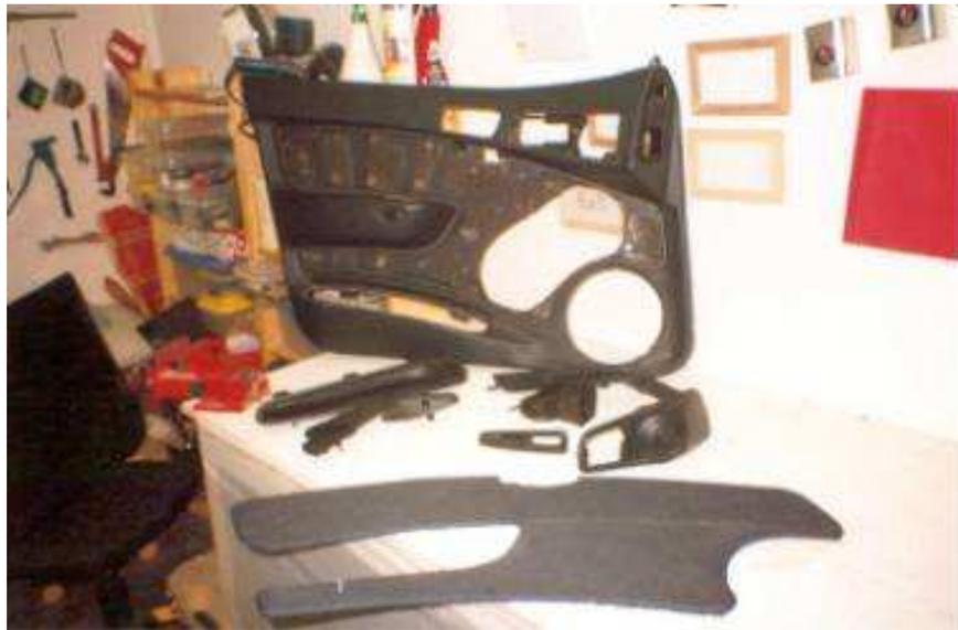
El siguiente paso consiste en presentar el 8" en la esquina, como es mayor el altavoz que la parte de la puerta a soportarlo pues se le añade un trozo de madera de DM de 5mm para aumentar la superficie, lo fabricaremos con un poco de forma preveiendo en un futuro la forma definitiva del panel
