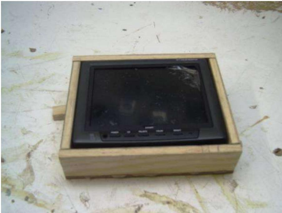
y la situamos dentro del soporte, utilizando cola caliente la sujetamos y probamos que entre correctamente y que su inclinación sea buena
