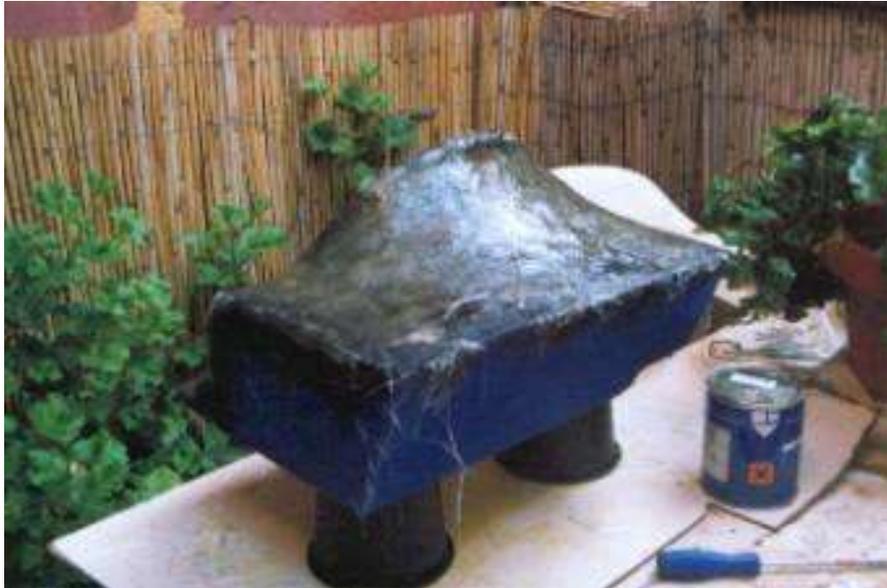
Como se observa en las fotografías la utilización de la resina esta obligada en sitios exteriores o muy ventilados. A partir de aquí ya es pan comido, abriremos con un fresolin el agujero para probar el 12", y la cajita para la conexión, a partir de aquí podemos optar por lijar y enmasillar el sub para tapizarlo con polipiel o seguir el camino que se siguió aquí, conseguir un efecto mullido y tapizado con tela fonoacustica gris.
