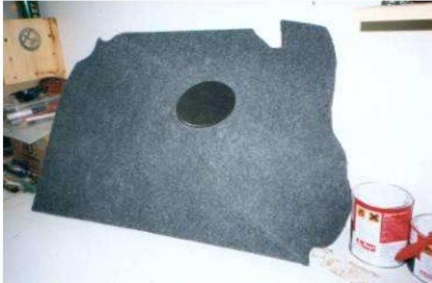
presentaremos la bandeja-sub, los laterales y la moldura teniendo en cuenta la medida longitudinal del maletero y cortando las puntas de la moldura central para ajustarse a la medida final.
