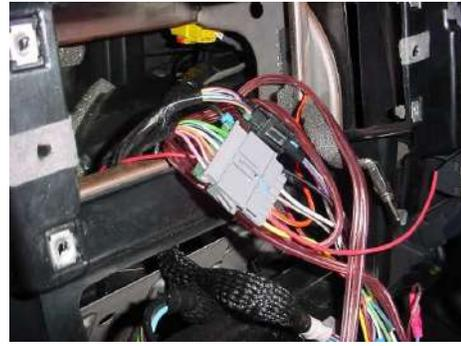
Una vez identificados los cables, procedemos a hacer la instalación del autoestereo, conectando cada uno en su respectivo lugar, así como los cables RCA de señal de audio (si se cuenta con algún otro equipo que se conectará al estereo) y el cable de antena.
