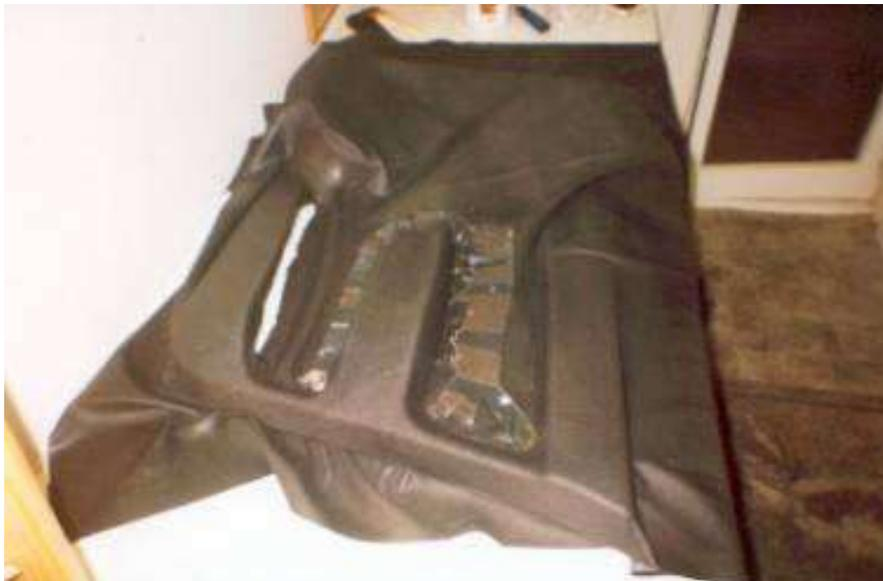
tapizada la puerta fabricamos con madera de DM de 5 mm la moldura que embellecerá el interior
