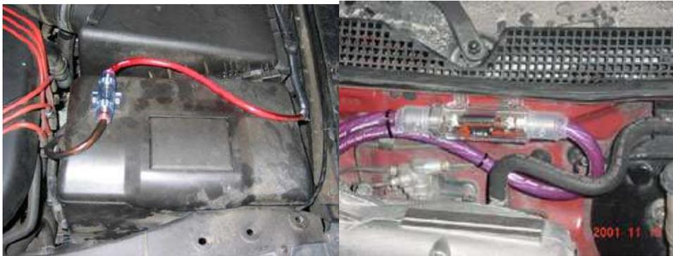
Este cable irá conectado directamente a tu amplificador, o al distribuidor de corriente o portafusibles (en caso de contar con más de un aparato). El valor de los fusibles se determina por la suma de los fusibles de cada uno de los aparatos en el equipo.
