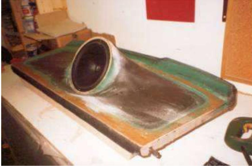
por dentro insonorizaremos las paredes de fibra y de madera para conseguir un sonido contundente y sin reverberaciones internas.
