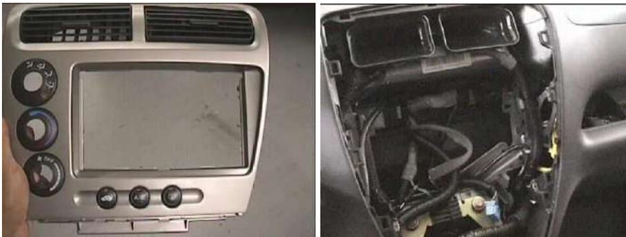
Después se monta nuevamente al rack en el tablero, y se coloca el adaptador que requiera tu vehículo para darle cabida a tu nuevo estereo.
