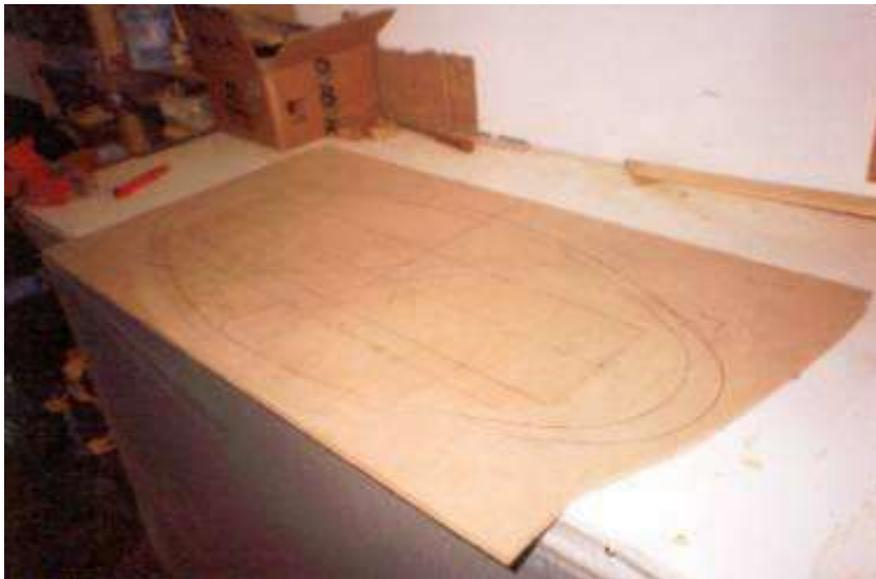
se dibuja dentro de la madera el dibujo de lo que haremos mas tarde en tridimensional, en este caso es un ovalo que en el centro hundidas van las dos etapas, por lo que partimos por cortar una madera que será la base de las dos etapas, con margen en las conexiones de los cables para poder doblar los cables sin mucha torsión.
