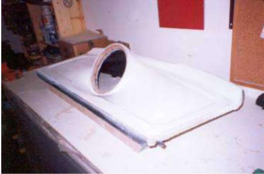
por la parte de detrás colocaremos la tapa y ajustaremos a las paredes encolándola y reforzándola con tornillos que deberán quedar embutidos para que al tapizar no se nos noten
