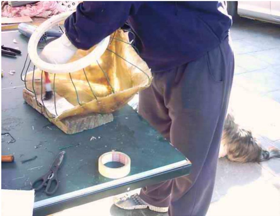
Cuando los tengamos todos enfibrados al molde ya podemos darles la forma con unos alicates u similar, meted el molde en el coche y id doblando los alambres hasta que os quede la forma mas o menos deseada, digo mas o menos porque ya os tocara luego darle a la masilla y a la lija.
