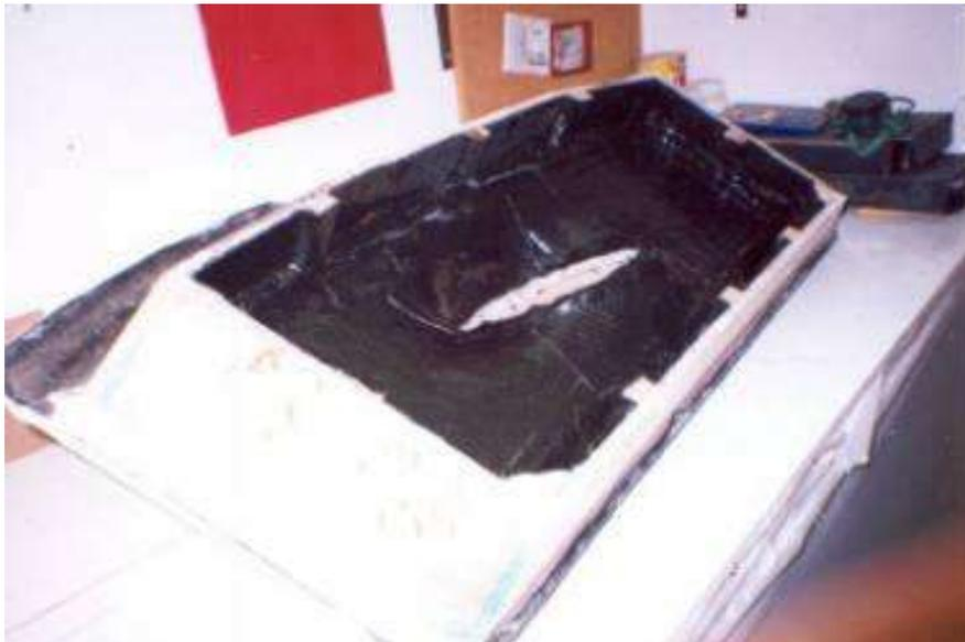
es la hora de dar una capa de imprimación para materiales difíciles y ver donde nos queda los defectos para volver a enmasillarlos y lijarlos
