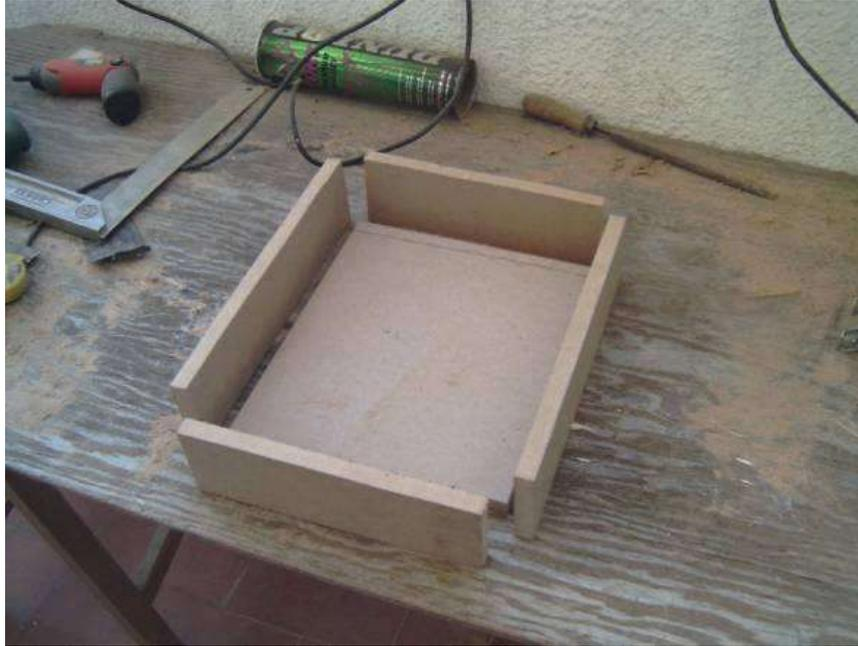
que montaremos en la ventana que hemos practicado a la tapa frontal y le practicaremos unos orificios que con tubos coarrugados haremos que comuniquen el cajón de la etapa con el exterior del sub, para que así la comunicación del exterior de los cables sea buena y no se pierda la estanqueidad del subwoofer.
