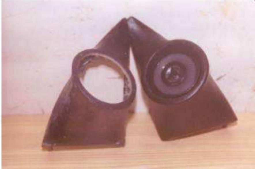
solo nos falta montar el altavoz por detrás, posiblemente las maderitas que nos aguantan el aro, nos molestaran, las retiráis y listos, no tengáis miedo a que pierda consistencia la nueva moldura ya que la resina de poliéster una vez seca no se deforma.
