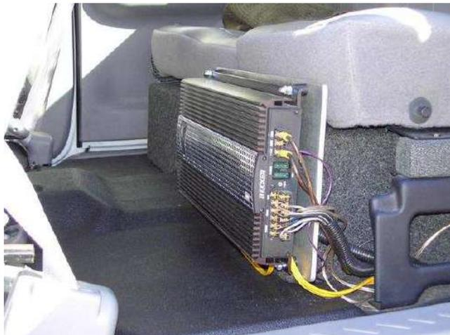
El positivo POWER o BATT irá conectado al portafusibles o distribuidor o a la batería directamente.
