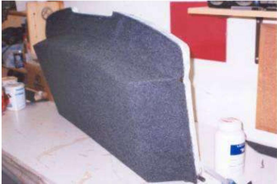
para evitar el peligro de que en una brusca frenada o de impacto frontal, la bandeja pudiera salir despedida contra los ocupantes, se ha introducido por dentro de la barra metálica que traspasa de punta a punta el sub., un cable trenzado de acero para posteriormente sujetarlo al chasis del maletero
