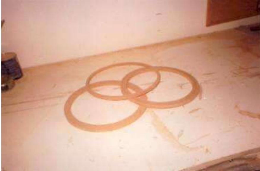
alrededor de la bandeja colocamos una moldura de madera para darle un poco de forma y que no se vea una bandeja muy plana ya que también entra en contacto con este tipo de trabajos la vista. Situamos el aro principal sujeto con unos toques de madera y cola termo difusora.
