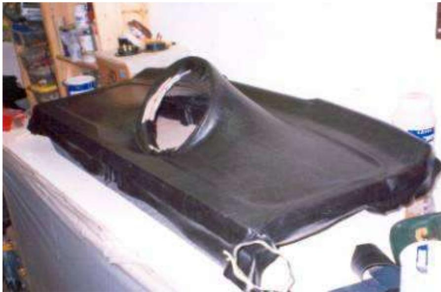
montamos la bandeja en el coche, realizando unos taladros laterales y sujetando el cable de acero a la estructura metaliza del maletero, por estos rincones siempre hay alguna barra de seguridad o la barra que sujeta los asientos traseros.
