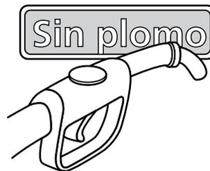
Su vehículo Ford está equipado con un catalizador y tiene una boca de carga del depósito de un diámetro menor que sólo permite usar las boquillas de los surtidores de combustible sin plomo.
