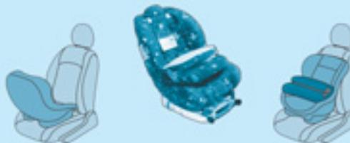
Se instala de espaldas la sentido de la circulación, únicamente en la plaza lateral trasera.
