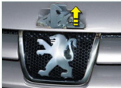
**Desde el exterior:** levante el mando, levante el capó y fije el soporte para mantener el capó abierto.
