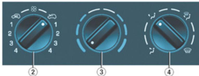
**El aire acondicionado no funciona cuando el mando de regulación de caudal de aire está en la posición mínimo.**
