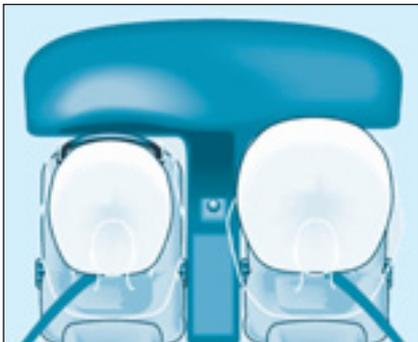
Están integrados en el centro del volante para el conductor y en el panel de instrumentos para el pasajero delantero y se disparan simultáneamente.
