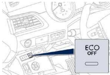
En caso de fallo de funcionamiento del sistema, el testigo del mando "ECO OFF" parpadea y luego se enciende de manera fija. Lleve a revisar el sistema a la Red PEUGEOT o a un taller cualificado.
