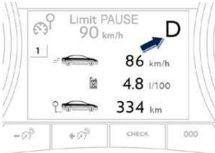
Cuando se desplaza la palanca por la rejilla para seleccionar una posición, el testigo correspondiente se enciende en el cuadro de a bordo.
