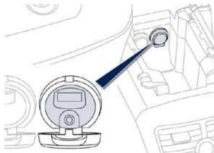
Este módulo de conexión, compuesto por una toma JACK y un puerto USB, está situado en el reposabrazos delantero (bajo la tapa). Permite conectar un dispositivo portátil, como un reproductor digital de tipo iPod® o una llave USB.
