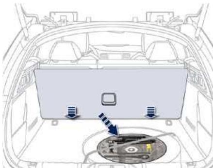
El utillaje está instalado debajo del suelo del maletero.
