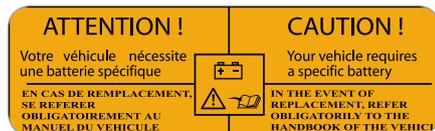
La presencia de esta etiqueta, especialmente con el Stop & Start, indica el uso de una batería de plomo de 12 V de tecnología y características específicas, que requiere, en caso de sustitución o desconexión, la intervención de la Red PEUGEOT o de un taller cualificado.
