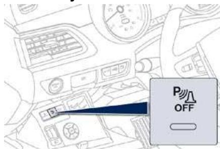
La función se neutraliza pulsando este botón. El testigo del botón se enciende. Al pulsar de nuevo este botón, se reactiva la función. El testigo del botón se apaga.
