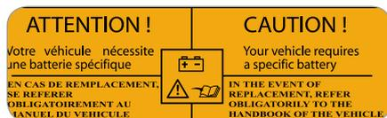
**!** Esta etiqueta indica el uso de una batería de plomo de 12 V de tecnología y características específicas, que requiere la intervención de la Red PEUGEOT o de un taller cualificado para su desconexión o sustitución. El incumplimiento de estas consignas puede provocar un desgaste prematuro de la batería.
