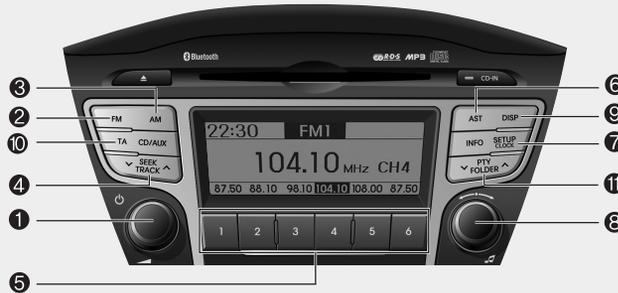
1. Mando de control volumen y botón de conexión/desconexión
