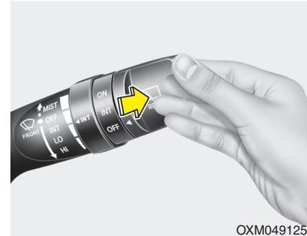
Empuje la palanca alejándola de usted para pulverizar líquido limpiacristales en la luna trasera y para activar el limpiaparabrisas trasero 1~3 ciclos. El rociado y el funcionamiento del limpiaparabrisas continuarán hasta que suelte la palanca. (opcional)
