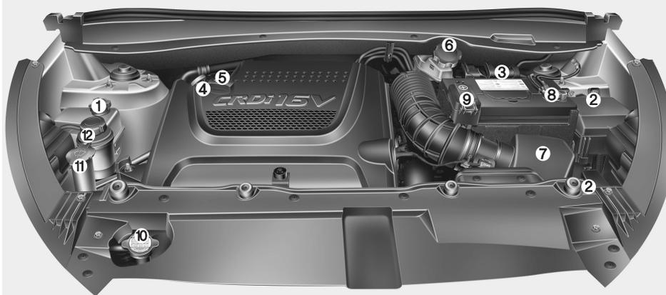
1. Depósito de refrigerante del motor
