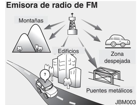
Las emisiones en FM se transmiten a frecuencias elevadas y las ondas no se curvan siguiendo la superficie terrestre. Por ello, las emisiones en FM comienzan por lo general a desvanecerse a escasa distancia de la emisora. Además, las señales de FM se suelen ver afectadas por edificios, montañas u otros obstáculos. Este puede inducirle a pensar que su aparato de radio tiene algún fallo. Las condiciones que se indican a continuación son normales y no indican averías en la radio.
