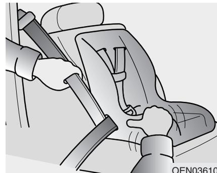
3. Enganche el cinturón de seguridad y deje que recupere la posible holgura. Una vez montado el sistema de sujeción, trate de moverlo en todas las direcciones para asegurarse de que está bien anclado.
