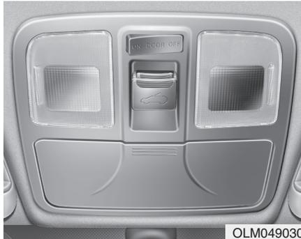
Si el vehículo está equipado con un techo solar, puede deslizar o inclinar su techo solar con la palanca de control ubicada en la consola superior.
