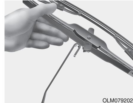
3. Levántelo hacia afuera del brazo del limpiaparabrisas.
