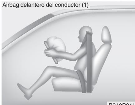
Los módulos de airbag delantero se encuentran en el centro del volante y en el panel del acompañante, por encima de la guantera. Cuando el SRSCM detecta un impacto frontal suficientemente fuerte, despliega automáticamente los airbags delanteros.
