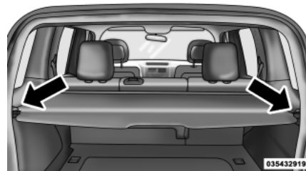
Colocación de la cubierta de zona de carga retráctil
