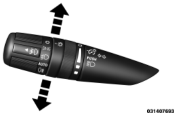
Control de intermitentes
