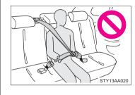
N'utilisez pas la ceinture de sécurité centrale arrière si l'une des boucles est retirée. Fixer une seule boucle pourrait occasionner des blessures graves, voire mortelles, en cas de freinage brusque ou de collision.
