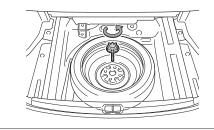
Loosen and remove the bolt.
