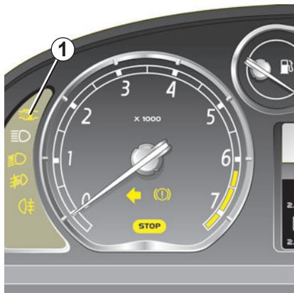
El testigo **1** se enciende para indicar un riesgo de saturación del filtro.
