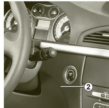
Inserte la tarjeta RENAULT en el lector de tarjeta 2. Pise el pedal del freno y/ o del embrague y proceda como se indica en «Arranque/parada del motor con tarjeta de telemando».
