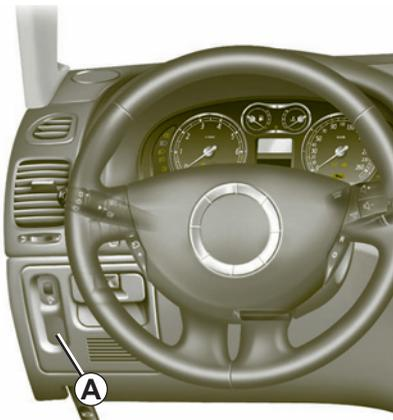
El mando **A** permite corregir la altura de los faros en función de la carga.
