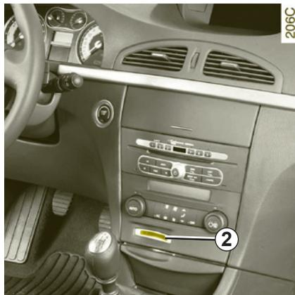
En caso de fallar la tarjeta RENAULT (parpadeo rápido del testigo **1** y del lector de tarjeta **2**), utilice, si es posible, la segunda tarjeta RENAULT (entregada con el vehículo).
