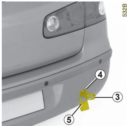
Utilice exclusivamente los puntos de remolcado delantero **1** y trasero **4** (nunca los tubos de transmisión). Estos puntos de remolcado tan sólo se pueden emplear para remolcar, en ningún caso deben servir para levantar directa o indirectamente el vehículo.
