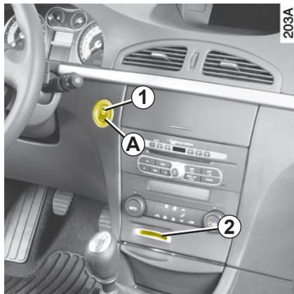
Al abrir la puerta, el lector de la tarjeta RENAULT **2** se enciende. El mensaje «insertar tarjeta» aparece en la matriz del cuadro de instrumentos.
