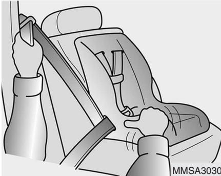
3. Enganche el cinturón de seguridad y deje que recupere la posible holgura. Una vez montado el sistema de sujeción, trate de moverlo en todas las direcciones para asegurarse de que está bien anclado.
