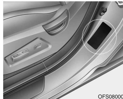
En la columna central del lado del conductor se encuentra un marcado E. Este marcado certifica que su vehículo cumple las regulaciones ECE de seguridad y medio ambiente.
