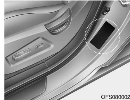
La etiqueta de certificación del vehículo sujeta en el panel exterior de la cara del conductor (o acompañante delantero) del montante central, contiene el número de identificación del vehículo (VIN).
