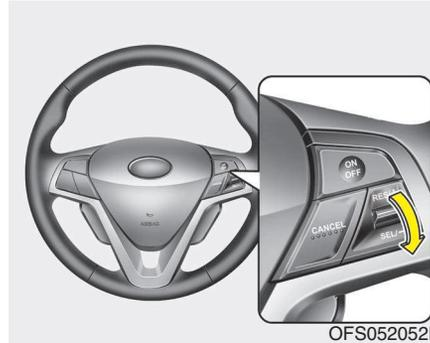
3. Mueva la palanca hacia abajo (a SET-) y suéltela a la velocidad deseada. Se encenderá el piloto indicador SET en el panel de instrumentos. Suelte el acelerador al mismo tiempo. La velocidad deseada se mantendrá constante de forma automática.
