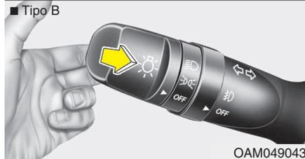
Para emitir ráfagas, tire de la palanca hacia usted. Al soltarla, volverá a su posición normal (luz de cruce). No es preciso llevar las luces encendidas para emitir destellos.
