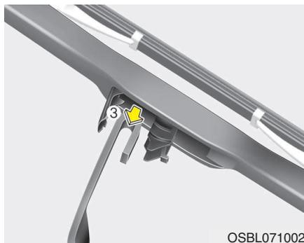
4. Empuje el brazo del limpiaparabrisas hacia abajo (3) y monte el nuevo conjunto de la escobilla siguiendo el proceso de desmontaje en sentido inverso.
