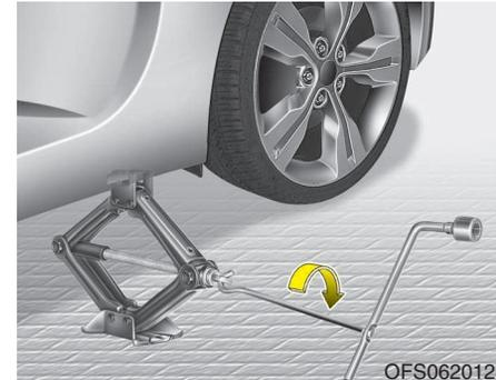
8. Introduzca la manivela en el gato y gírela en el sentido de las agujas del reloj, elevando el vehículo hasta que la rueda se separe del suelo. Esta distancia es de aproximadamente 30 mm (1,2 pulg.). Antes de sacar las tuercas de las ruedas, asegúrese de que el vehículo se mantiene estable y que no hay riesgo de que se mueva o se deslice.
