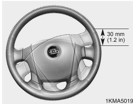
Estacione el vehículo en una superficie horizontal, arranque y coloque las ruedas en la posición de marcha recta hacia delante. Gire el volante a izquierda y derecha y compruebe el juego antes de sentir la resistencia que ofrece el giro de los neumáticos.
