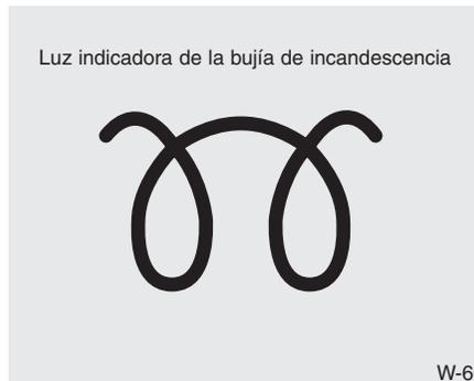
4. Cuando se apague la luz indicadora de la bujía de incandescencia, lleve el contacto a la posición START y manténgalo en ella hasta que arranque el motor (10 segundos como máximo); a continuación, suelte la llave.
