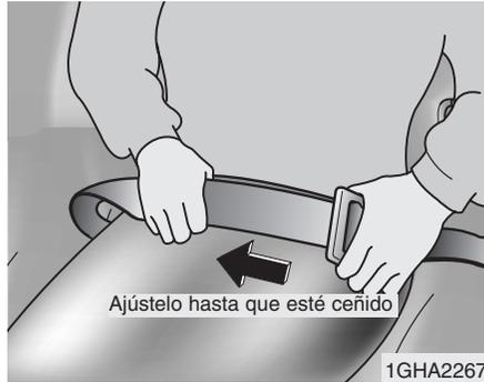
3. Tome el extremo libre del cinturón y tire de él hasta que quede ceñido sobre las caderas y la parte inferior del abdomen. Si necesita alargar o acortar el cinturón, mantenga la lengüeta de la placa del pestillo en ángulo recto con la banda y tire.
