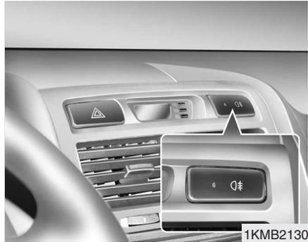
Para apagar los pilotos antiniebla traseros, presione de nuevo el interruptor correspondiente o lleve el mando de luces a la posición de apagado.
