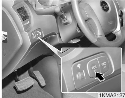
El sistema de control de tracción (TCS) ayuda a que el vehículo acelere en superficies deslizantes impidiendo que las ruedas motrices giren excesivamente. También mejora la tracción y el control de la dirección.
