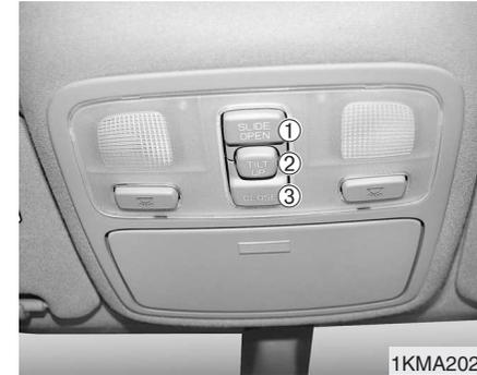
Si su vehículo está equipado con esta opción, puede deslizar o inclinar el techo solar con los botones de mando correspondientes, situados en la consola que está sobre el parabrisas.
