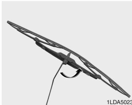
1. Levante el brazo del limpiaparabrisas y gire el conjunto de la escobilla hasta que vea la presilla de sujeción de plástico.
