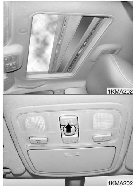
**Deslizamiento del techo solar**
