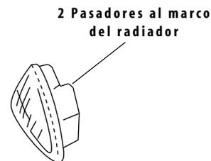
Figura 14 | Unión del conjunto faro
