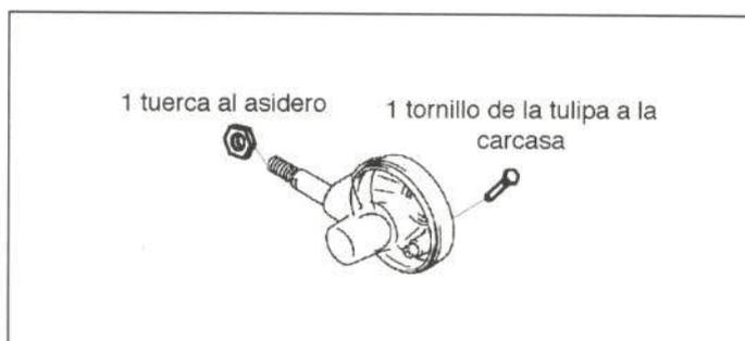
**Figura 22.-** Unión del intermitente trasero
