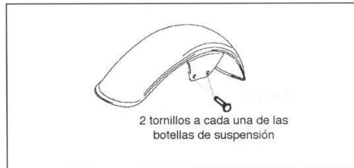
**Figura 37.-** Unión del guardabarros delantero
