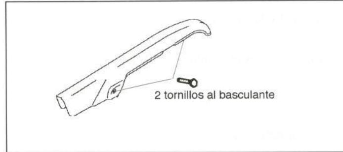
Figura 25.- Unión del cubrecadenas
