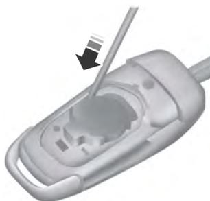
**Nota:** No toque los contactos de la pila ni la tarjeta de circuito impreso con el destornillador.
