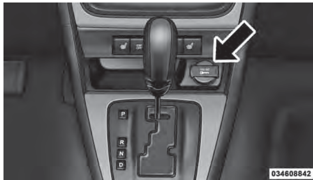
Toma de corriente
