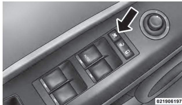
Interruptor de seguro de ventanillas
