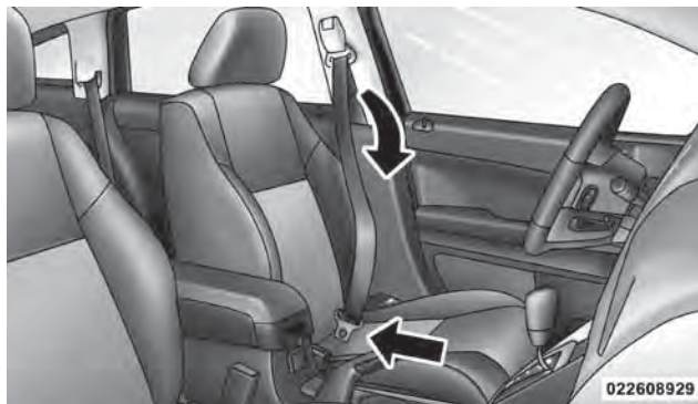
Inserte la hebilla en la contra hebilla
