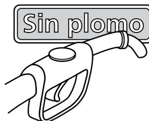
En los vehículos con motores a nafta el cuello del depósito de combustible tiene un diámetro estrecho que sólo admite la boquilla de la pistola de los surtidores de combustible sin plomo.
