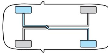
**¡Atención!** En caso que uno de los dos circuitos de freno fallara, se tendrá que ejercer mayor fuerza sobre el pedal de freno, y posiblemente sea mayor la distancia de frenado. Dirigirse inmediatamente a un Concesionario Ford para verificar el sistema.
