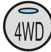
En este modo, el sistema provee tracción integral en las cuatro ruedas. Es apropiado para la conducción fuera del camino (off-road) por período prolongado, tales como: barro, arena o nieve. Las luces indicadoras del panel de instrumentos y del interruptor indican que el sistema 4WD Integral está activado.
