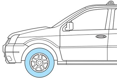
Si tiene que conducir sobre bordes o cordones bajos de veredas, hágalo a baja velocidad y si es posible, crúcelos en ángulo recto. Se debe evitar conducir sobre obstáculos altos y con bordes agudos. Al estacionar el vehículo, no permita que los neumáticos rocen lateralmente los bordes.
