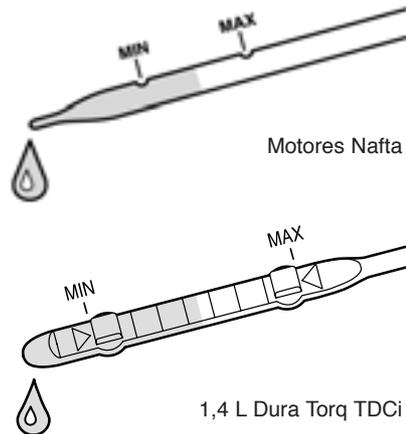
El nivel de aceite podrá verse en la película que queda adherida a la varilla. Si el nivel está entre las marcas MIN y MAX, no es necesario agregar aceite. Cuando el aceite está caliente el nivel puede pasar algunos milímetros de la marca MAX, debido a la expansión térmica.
