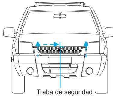
3. Levantar totalmente la tapa del capó y apoyarlo en su varilla soporte.
