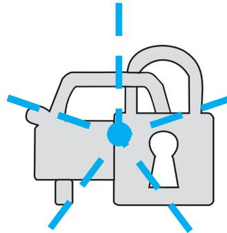
**¡Atención!** Para asegurar un intercambio de datos impecables entre el vehículo y la llave, evite interponer objetos metálicos entre ambos.
