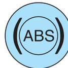
**¡Atención!** En estas condiciones (ambas luces encendidas), será necesario aplicar más fuerza sobre el pedal de freno. Mantenga una mayor distancia con el vehículo que marcha delante, para mayor seguridad en los frenajes.
