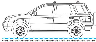
Si la caja de cambios y la caja de transferencia (vehículo 4x4) fuesen sumergidas en agua, sus fluidos deben ser verificados, y si es necesario, reemplazados. El ingreso de agua en la transmisión podrá dañarla irremediablemente.
