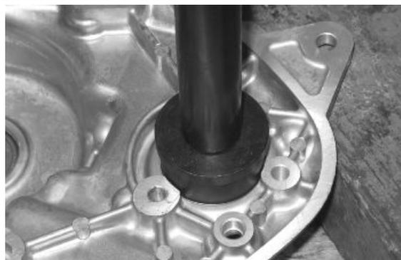
**Utillaje específico****020363Y Guía de 20 mm****020358Y Adaptador 37 x40 mm****020151Y Calefactor de aire****020376Y Mango para adaptadores**
