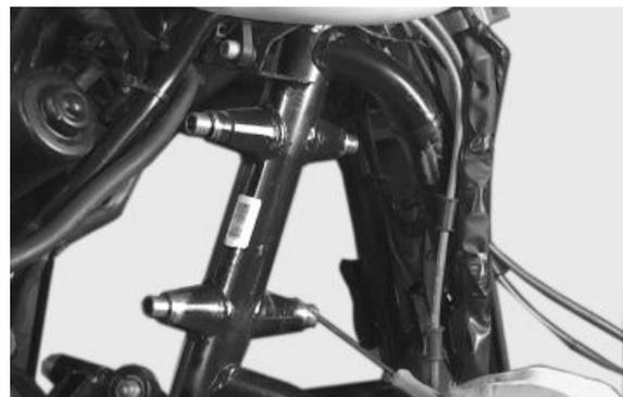
En el montaje, proceder con las operaciones en sentido inverso al desmontaje, tomando la precaución de lubricar los pernos de referencia ubicados en los semibrazos del paralelogramo y respetando los pares prescritos.
