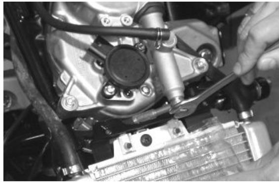
Quitar los tres tornillos de fijación que se muestran y desmontar todo el motorreductor.
