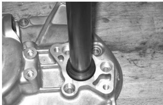
Sostener el cárter para obtener una posición perfectamente horizontal, calentarlo con la herramienta específica, pistola térmica, a una temperatura de aproximadamente 120 °C, utilizar la herramienta específica para instalar el cojinete del eje de mando de la palanca de transmisión flexible, si es necesario, aplicar golpes de mazo. Montar Seeger de seguro cojinetes.
