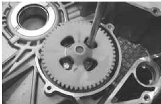
**Pares de apriete (N\*m)****Tornillos de fijación de la bomba de aceite al cárter 5 ÷ 6**
