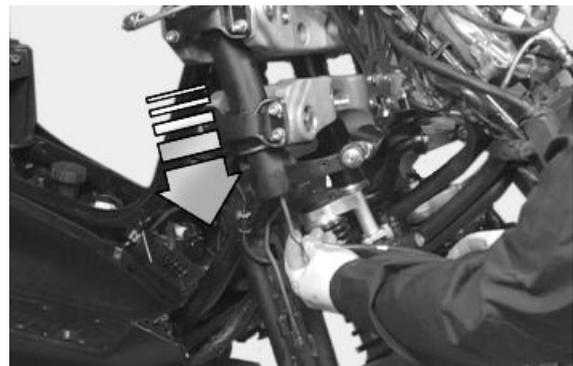
Sacar la parte de la tubería flexible de la pinza freno del tubo dirección como se indica en la foto, luego sacar la parte rígida del tubo de dirección.
