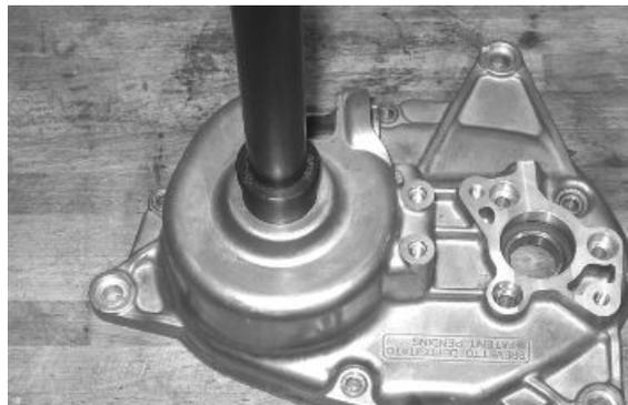
Con la herramienta específica, extraer el cojinete del motor eléctrico.
