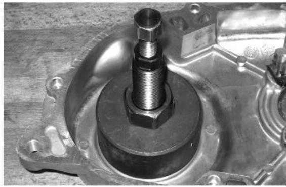
Con la herramienta específica extraer el cojinete del motor eléctrico.
