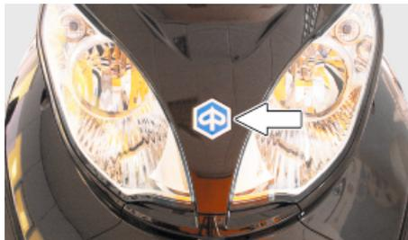
Desenroscar el tornillo situado debajo del escudo y retirar la cubierta central del grupo óptico
