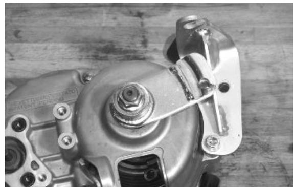
Montar el potenciómetro (no forzar el montaje, el encastre en "D" garantiza un solo posicionamiento) con el conector orientado del lado opuesto a la bomba hidráulica.
