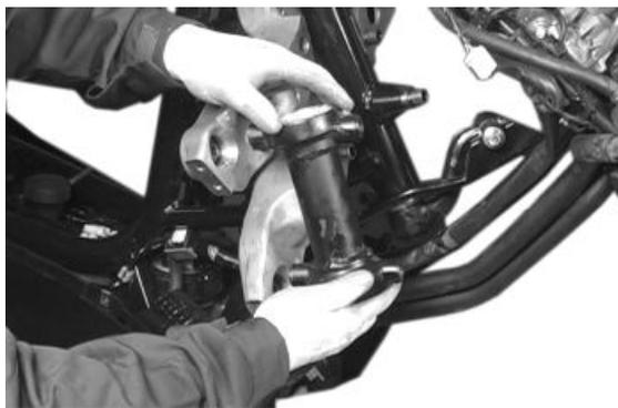
Controlar visualmente los alojamientos de los cojinetes superiores e inferiores en los manguitos de dirección y sus respectivos cojinetes. Si se presentan signos anómalos de desgaste, sustituirlos.
