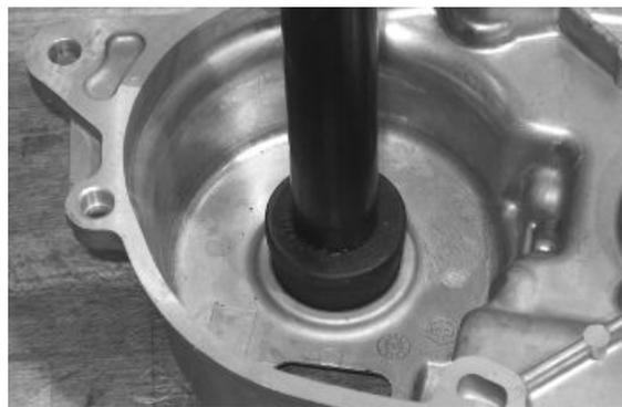
**Utillaje específico****020151Y Calefactor de aire****020376Y Mango para adaptadores****020362Y Guía de 12 mm****020357Y Adaptador 32 x 35 mm**
