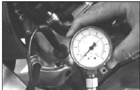
**5** - Medir la presión con motor frío y en ralentí.
