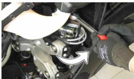
Poner la tuerca anular superior en el extremo de la rosca del tubo de la suspensión lateral
