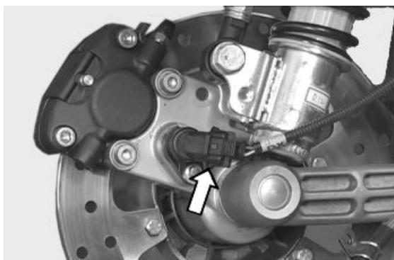
Quitar el racor de la tubería hidráulica del dispositivo bloqueo de deslizamiento tomando la precaución, también en este caso, de recoger el líquido que sale.
