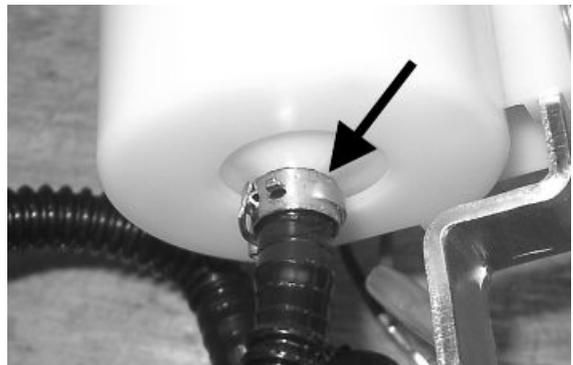
Retirar la parte inferior del soporte bomba como se muestra en la foto.
