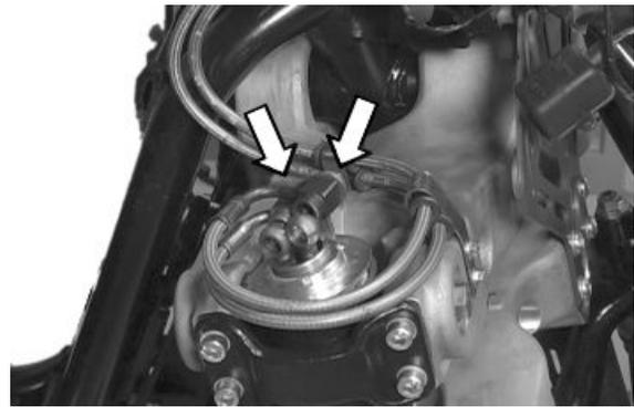
Sacar la tubería del dispositivo de roll lock suspensión, del manguito de dirección.
