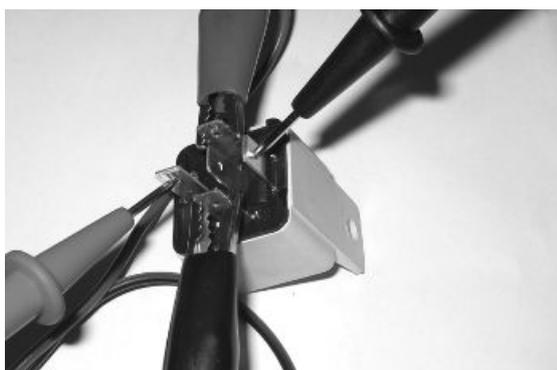
Controlar la línea de alimentación de la bobina de excitación telerruptor cargas inyección: conmutando en "ON" controlar la presencia de tensión batería, por 2 segundos, entre el cable Rojo-Blanco y Negro-Violeta del soporte telerruptor. En caso contrario, controlar la continuidad del cable Rojo-Blanco entre la caja de fusibles y el soporte telerruptor y del cable Negro-Violeta entre el pin 20 de la centralita y el soporte del telerruptor.
