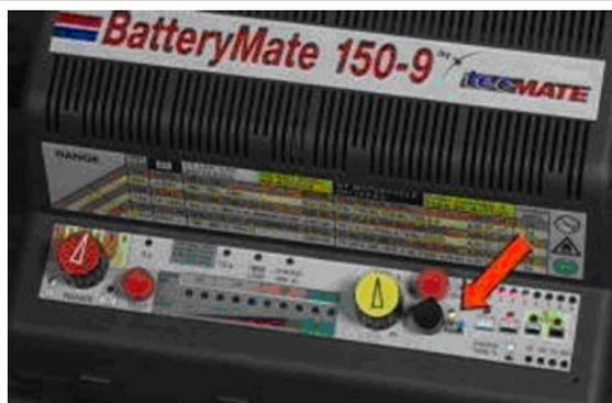
g - El ciclo de activación de la nueva batería tiene una duración de 30 minutos, transcurridos los cuales se enciende el led que indica que se efectuó la recarga
