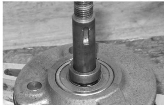
Lubricar las zonas de interferencia, acoplar los dos semicárteres, aplicar ligeros golpes de mazo para que los dos semicárteres entren en contacto. Posicionar el estribo de soporte de la transmisión flexible, montar los cuatro tornillos, apretar con el par prescrito.
