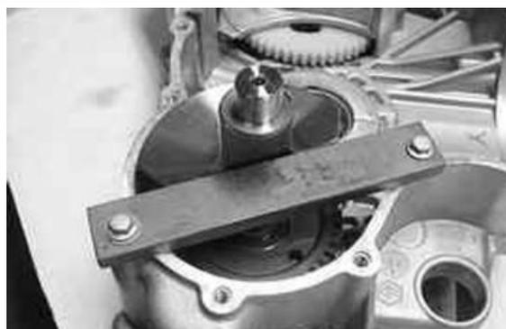
**Utillaje específico****020479Y Llave de detención contraeje**
