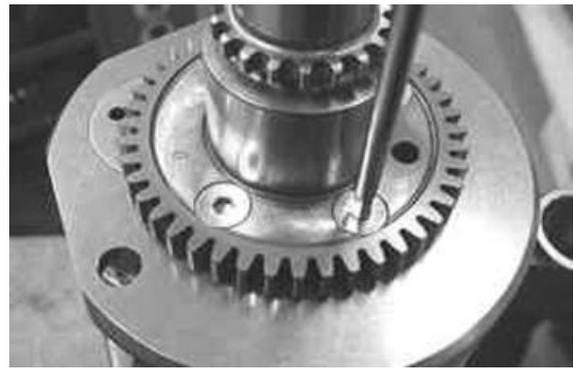
Soplar con aire comprimido y desengrasar los orificios de fijación de ambas superficies de manera que el LOCTITE tome.
