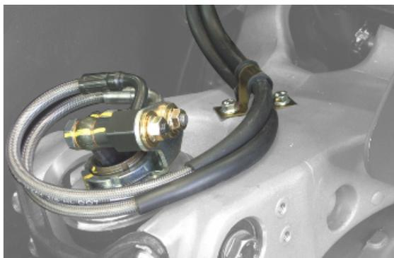
bloqueo suspensión, para permitir que se libere la tubería de freno.
