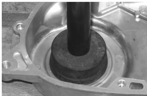
Sostener el cárter para obtener una posición perfectamente horizontal, calentarlo mediante la herramienta específica, pistola térmica, a una temperatura de aproximadamente 120 °C, utilizar la herramienta específica para instalar el cojinete del motor eléctrico, si es necesario, aplicar golpes de mazo.
