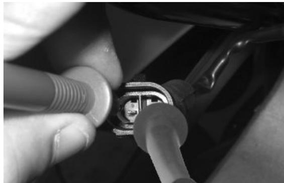
Con el mazo de cables interfaz desconectado de la centralita, controlar la continuidad entre el pin 34 y el cable marrón del conector sensor pinza roll lock lado instalación.
