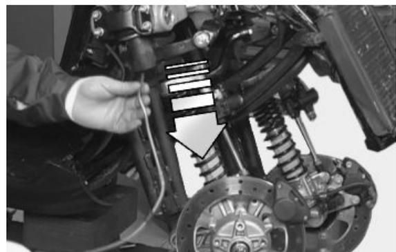
Quitar el mazo de cables de la rueda fónica desconectando el conector ubicado en el depósito de gasolina después de sacar la cubierta central del chasis.
