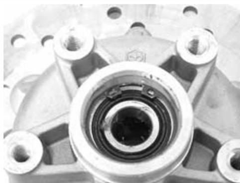
Retirar el cojinete de bolas utilizando la herramienta específica
