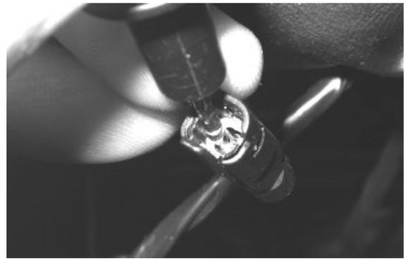
Con mazo de cables de interfaz desconectado de la centralita y los conectores desconectados de los sensores revoluciones rueda controlar que los pines 23 - 17 y 24 - 17 estén aislados entre sí y de la masa.
