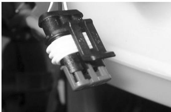
Con el conmutador de llave en ON, controlar la presencia de tensión de la batería entre los cables Rojo-Blanco y Negro
