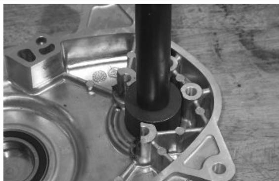
**020376Y Mango para adaptadores****020477Y Adaptador 37 mm**
