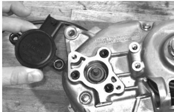
Quitar la tuerca que se muestra en la figura, si es necesario bloquear en un tornillo de banco la palanca sin arruinar la superficie.
