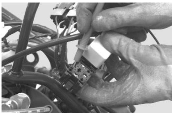
Si, conmutando a «ON», la bomba después de 2 segundos de activación continúa girando, controlar con la centralita desconectada y el telerruptor cargas inyección desactivado, que el cable Negro-Violeta (pin 20 en el mazo de cables interfaz) esté aislado de la masa.
