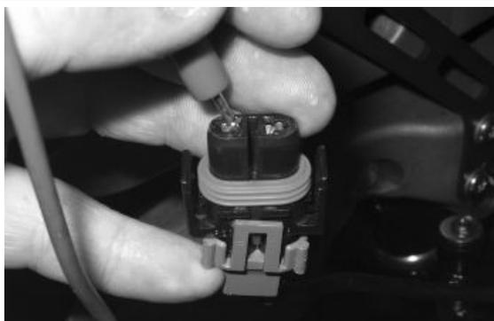
Con mazo de cables interfaz desconectado de la centralita controlar la continuidad entre el pin 28 y el cable Blanco-Rojo, entre el pin 38 y el cable Azul del conector del motorreductor
