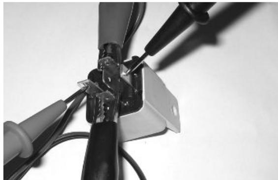
Controlar la línea de alimentación de la bobina de excitación telerruptor cargas inyección: al cambiar a «ON» controlar durante 2 segundos la presencia de tensión batería entre el cable Rojo-Blanco y el Negro-Violeta del soporte del telerruptor. En caso contrario, controlar la continuidad del cable Rojo-Blanco entre la caja de fusibles y el soporte telerruptor y del cable Negro-Violeta entre el pin 20 de la centralita y el soporte del telerruptor.
