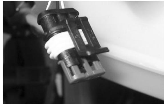
Con el conmutador de llave en ON, controlar la presencia de tensión de la batería entre los cables Rojo-Blanco y Negro
