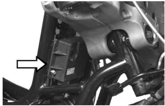
Quitar las fijaciones de acoplamiento de los brazos del paralelogramo aflojando las fijaciones indicadas.
