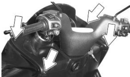
Una vez retirados los plásticos, se accede a las tuercas anulares del tubo lateral de la suspensión delantera
