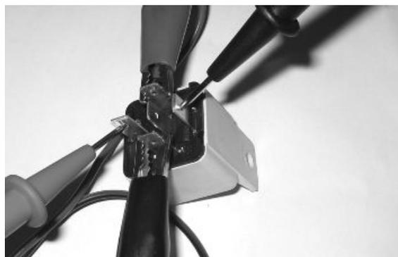
Controlar la línea de alimentación de la bobina de excitación telerruptor cargas inyección: conmutando en "ON" controlar la presencia de tensión batería, por 2 segundos, entre el cable Rojo-Blanco y Negro-Violeta del soporte telerruptor. En caso contrario, controlar la continuidad del cable Rojo-Blanco entre la caja de fusibles y el soporte telerruptor y del cable Negro-Violeta entre el pin 20 de la centralita y el soporte del telerruptor.
