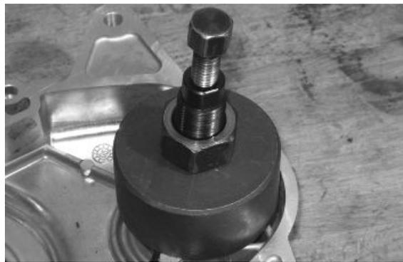
Sostener el cárter para obtener una posición perfectamente horizontal, calentarlo con la herramienta específica, pistola térmica, a una temperatura de aproximadamente 120 °C, utilizar la herramienta específica para instalar el cojinete del grupo muelle/sector dentado, si es necesario, aplicar golpes de mazo.
