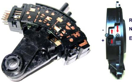
Gracias al selector es posible escoger el modo de funcionamiento del control del cambio e insertar la marcha atrás (**R-N-E**). Una vez seleccionado el modo manual **M** se comunica que el conductor desea seleccionar una marcha superior (+) o inferior (-).
