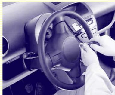
Mediante una operación análoga es posible retirar el tornillo colocado abajo a la derecha del cuadro de instrumentos.
