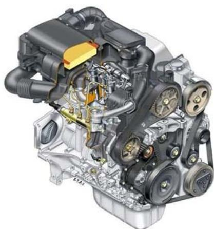
El motor **diésel DV4-TD** en la versión con potencia limitada de 54 CV, ha sido diseñado por PSA Peugeot Citroën. La motorización diésel deriva del 1.4 HDi, que equipa los otros coches compactos de la serie Citroën y Peugeot, con una potencia de 40 kW a 4.000 rpm y un par de 130 Nm a 1.750 rpm.
