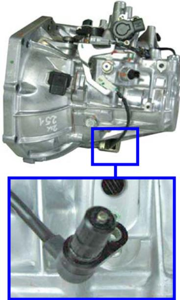
Se trata de un sensor inductivo colocado en la parte inferior del cambio y protegido por un pequeño cárter de chapa. Su posición requiere atención durante las operaciones de desmontaje de la transmisión. Si se apoya el cambio en el suelo se corre el riesgo de dañar el sensor.
