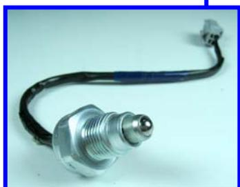
Este interruptor comunica a la centralita la inserción de la relación de marcha atrás. Además, enciende la luz correspondiente. Para realizar la comprobación medir la resistencia del sensor en ambas condiciones de "Desembragado" y "Embragado".
