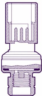
En caso de **caída de presión**, debida por ejemplo a fugas del líquido refrigerante, el control motor desactiva el embrague para evitar dañar el compresor.
