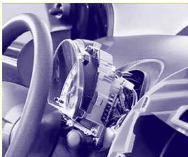
Para retirar la cubierta superior del tablero es necesario quitar la consola central con el grupo de autoradio y la cubierta del cuadro de instrumentos.
