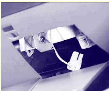
Quitar el tornillo de sujeción y desconectar el conector amarillo del airbag del acompañante.
