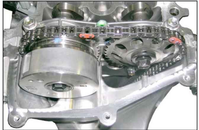
El calculador del motor utiliza toda la información sobre el régimen de giro, la presión en el colector, la posición de la mariposa y la temperatura del motor para determinar el mejor momento para abrir, y luego cerrar, las válvulas de admisión.
