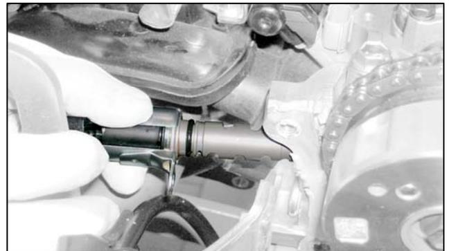
Gracias a la medición del sensor de fase y a la del sensor de RPM / PMS, el control del motor puede averiguar continuamente la posición real alcanzada por el árbol de levas respecto a la orden enviada a la electroválvula.
