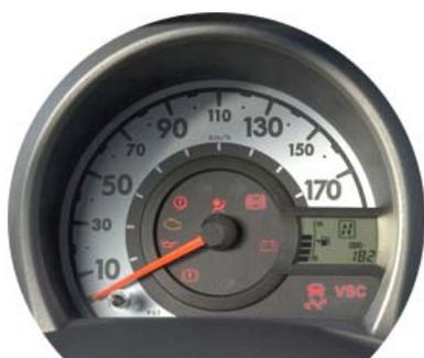
La centralita electrónica ABS-VSC está equipada con la función de autodiagnóstico que controla la eficacia del sistema durante el arranque y la marcha del vehículo.
