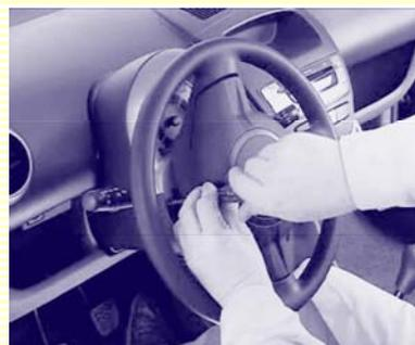
Girar el volante a la izquierda para poder retirar el tornillo colocado en la parte inferior izquierda del cuadro de instrumentos.
