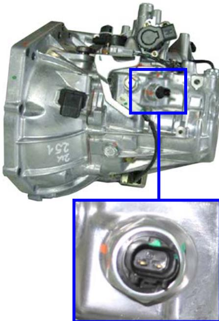
El sistema permite el arranque del motor sólo con el cambio en posición N. Por lo tanto, además de comprobar la posición de la palanca selectora, con este sensor es necesario asegurarse de que el cambio se encuentre en posición de punto muerto.
