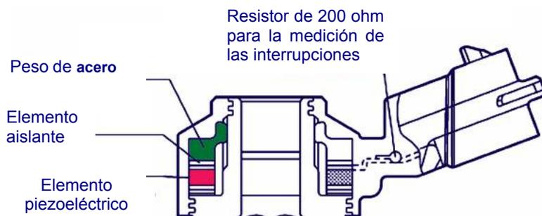
La señal filtrada y amplificada se transmite a la centralita que es capaz de diferenciar los picos de señal de energía elevada típicos de la detonación, del "ruido" de la combustión normal.
