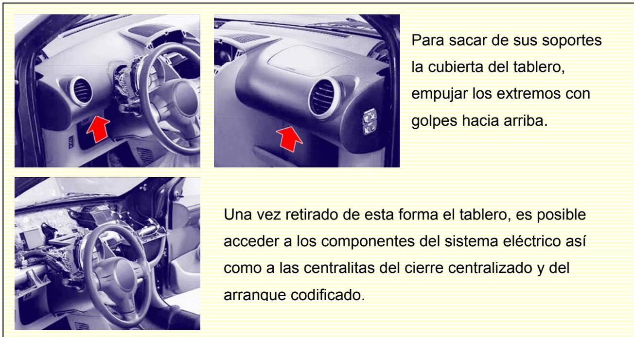
Para sacar de sus soportes la cubierta del tablero, empujar los extremos con golpes hacia arriba.
