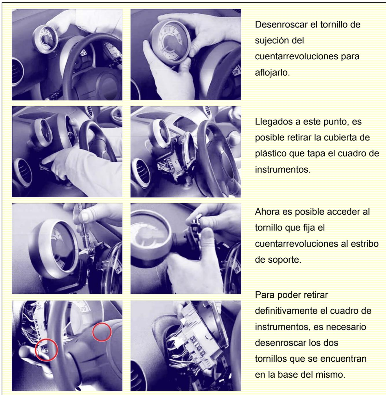
Desenroscar el tornillo de sujeción del cuentarrevoluciones para aflojarlo.
