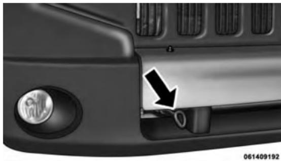
**Anilla para remolque delantera instalada**
