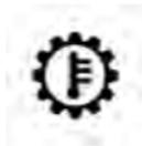
Esta luz indica que la temperatura del líquido de la transmisión está caliente. Esto puede ocurrir con el uso intenso, como el arrastre de remolque. Si esta luz se enciende, apártese con seguridad de la carretera y detenga el vehículo. Luego, cambie la transmisión a la posición NEUTRA y haga funcionar el motor en ralentí o más rápido hasta que la luz se apague.
