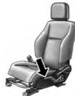
Palanca de ajuste de altura del asiento
