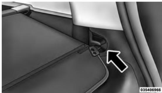
Guías de la cubierta de carga
