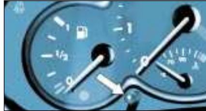
Luces encendidas, pulse el botón para variar la intensidad de iluminación del combinado y de la pantalla multifunción. Cuando la iluminación alcanza el reglaje mínimo (o máximo), suelte el botón y vuelva nuevamente a pulsarlo para aumentar la intensidad (o disminuirla).
