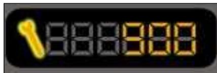
5 segundos después de poner el contacto, el totalizador kilométrico vuelve a su funcionamiento normal y la llave se queda encendida.
