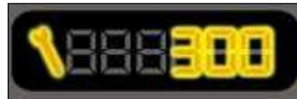
5 segundos después de poner el contacto, el totalizador kilométrico vuelve a su funcionamiento normal y la llave de mantenimiento se queda encendida. La pantalla indica el kilometraje total y parcial.
