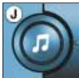
Efectúe impulsos sucesivos en la tecla **J** para acceder a los reglajes de los graves (**BASS**), de los agudos (**TREB**), del loudness (**LOUD**), del fader (**FAD**), del balance (**BAL**) y de la corrección automática del volumen.
