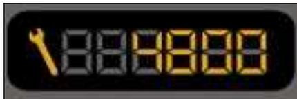
5 segundos después de poner el contacto, el totalizador kilométrico vuelve a su funcionamiento normal y la pantalla indica el kilometraje total y parcial.
