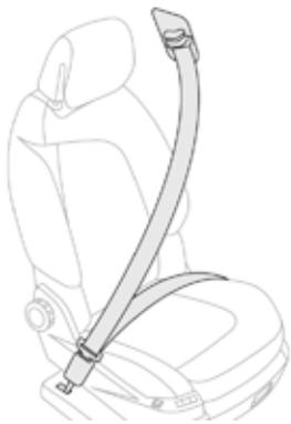
Los cinturones de seguridad delanteros están equipados con un sistema de pretensión pirotécnica y con limitador de esfuerzo. Este sistema mejora la seguridad en las plazas delanteras en caso de choque frontal o lateral.
