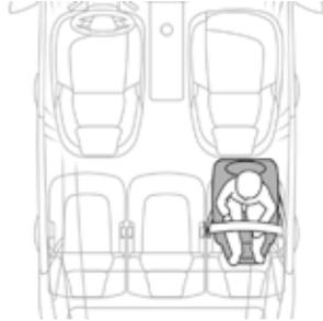
Quando instale una silla infantil "de espaldas al sentido de la marcha" en una **plaza trasera**, avance el asiento delantero y coloque el respaldo en posición recta de manera que la silla instalada "de espaldas al sentido de la marcha" no toque el asiento delantero del vehículo.
