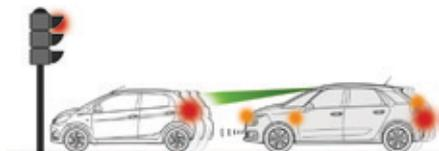
El objetivo de esta función, también denominada frenada automática de urgencia, es reducir la velocidad de impacto o evitar la colisión frontal del vehículo en caso de no intervención por parte del conductor. Mediante el radar y la cámara, esta función actúa en los frenos del vehículo.
