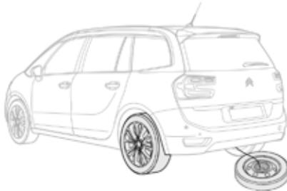
La rueda de repuesto está fijada bajo el vehículo mediante un sistema de tornos.
