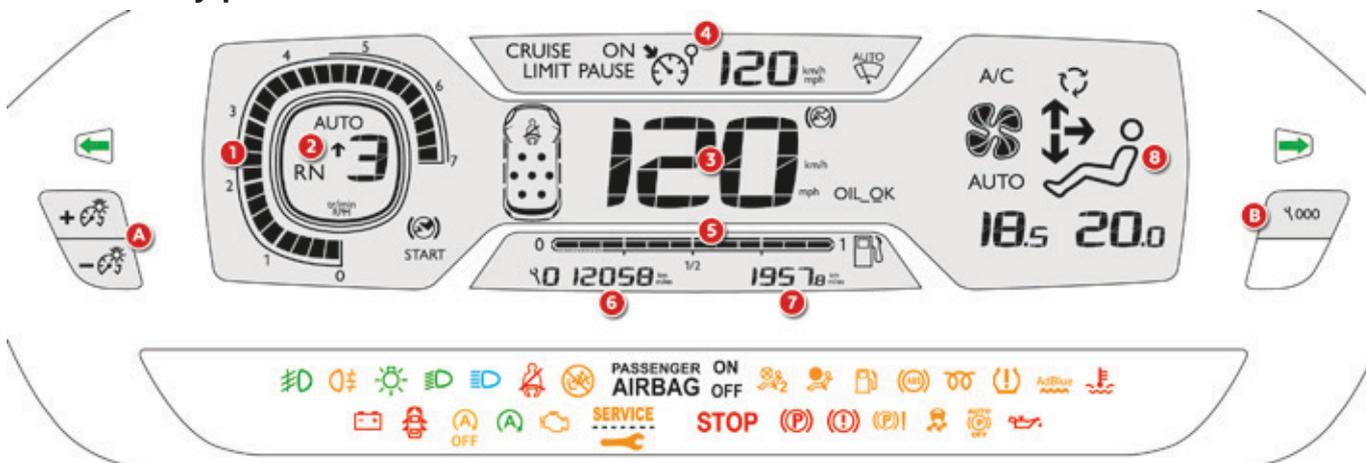
1. Cuentarrevoluciones (x 1 000 rpm), gradación según motorización (gasolina o diésel).
