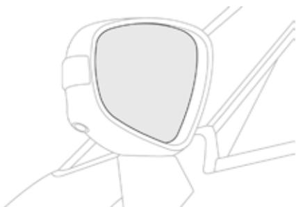
Cada retrovisor está equipado con un espejo regulable que permite la visión trasera lateral necesaria para las situaciones de adelantamiento o estacionamiento. Los retrovisores pueden plegarse para estacionar en lugares estrechos.
