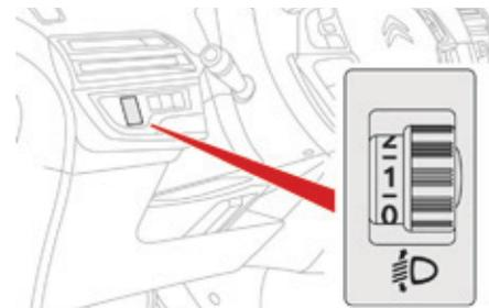
Para no molestar a los demás usuarios de la vía, la altura de los faros se debe regular en función de la carga del vehículo.
