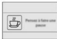
Esta alerta se traduce mediante la indicación de un mensaje que le propone realizar una pausa, acompañado de una señal sonora. Si el conductor no sigue esta recomendación, la alerta se repetirá cada hora hasta que se detenga el vehículo.
