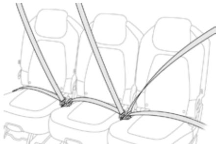
Cada una de las plazas traseras está equipada con un cinturón de seguridad, provisto de tres puntos de anclaje y un enrollador con limitador de esfuerzo (salvo para el pasajero trasero central).
