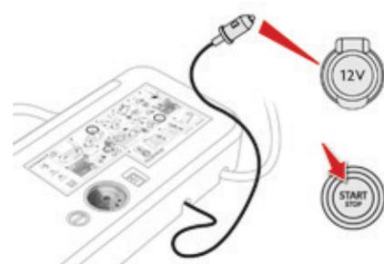
☞ Conecte la toma eléctrica del compresor a la toma de 12 V del vehículo.
