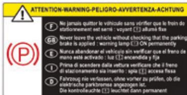
**!** Antes de salir del vehículo, verifique que el freno de estacionamiento esté tensado: los testigos de freno de estacionamiento deben estar encendidos de manera fija en el cuadro de a bordo y en el mando. Si el freno de estacionamiento no está tensado, se emitirá una señal sonora y un mensaje aparecerá al abrir la puerta del conductor.
