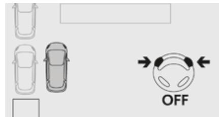
La maniobra finaliza cuando el eje delantero del vehículo está fuera de la plaza. Al finalizar la maniobra, el testigo de funcionamiento se apaga en el cuadro de a bordo, acompañado de un mensaje y de una señal sonora. La asistencia se desactiva: retome el control del vehículo.
