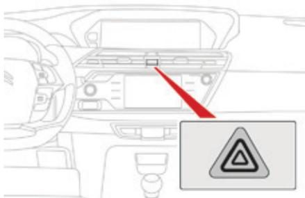
Alerta visual a través del encendido de los indicadores de dirección para prevenir a los demás usuarios de la vía en caso de avería, de remolcado o de accidente de un vehículo.
