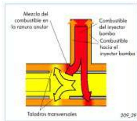
Sin el tubo distribuidor se tendría una temperatura heterogénea del combustible en los inyectores bomba.
