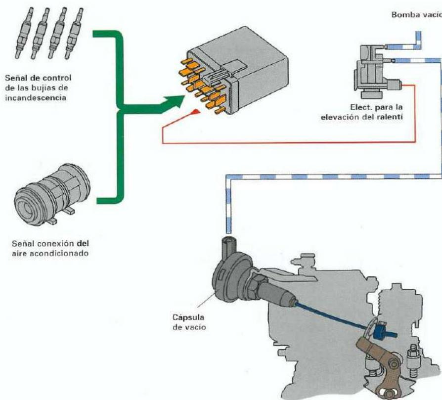
Este dispositivo de elevación del ralentí se monta en los motores siempre y cuando estén equipados con aire acondicionado. De no ser así se incorpora el ya conocido mecanismo de elevación del ralentí en frío con cápsula de cera.
