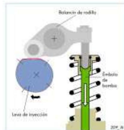
El flanco descendente achatado produce un movimiento lento y uniforme del émbolo hacia arriba, permitiendo que el combustible pueda refluir sin burbujas hacia la cámara de alta presión del inyector bomba, sin producir burbujas.
