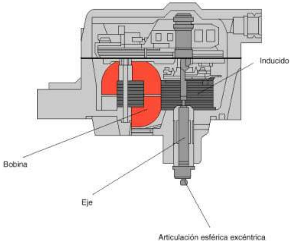
El dosificador de caudal va montado en la parte superior de la bomba de inyección. El transforma las señales procedentes de la unidad de control electrónica en modificaciones de la posición de la corredera reguladora. Para ello, las señales eléctricas recibidas se transforman, aplicando el principio del motor eléctrico, en movimientos predefinidos del eje de accionamiento con articulación esférica excéntrica.
