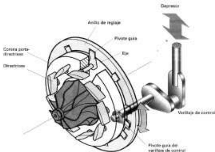
Para conseguir una rápida generación de la presión de sobrealimentación a regímenes bajos y a plena carga se ajustan las directrices de modo que produzcan una estrecha sección de entrada.
