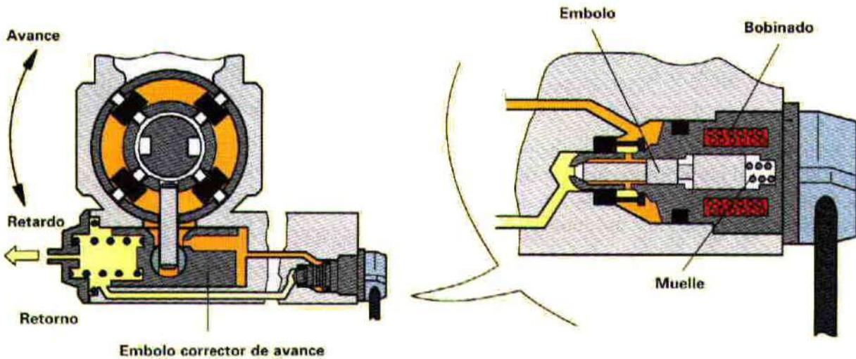
La electroválvula para regulación del comienzo de inyección está ubicada en la parte inferior de la bomba inyectora.
