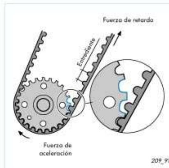
En una polea dentada del cigüeñal con un juego de entrediente uniforme, los dientes de la correa topan contra los bordes de los dientes en la polea, en cuanto la correa es sometida a cargas intensas por parte de las fuerzas de bomba. Como consecuencia se manifiesta un alto desgaste y una reducida vida útil de la correa dentada.
