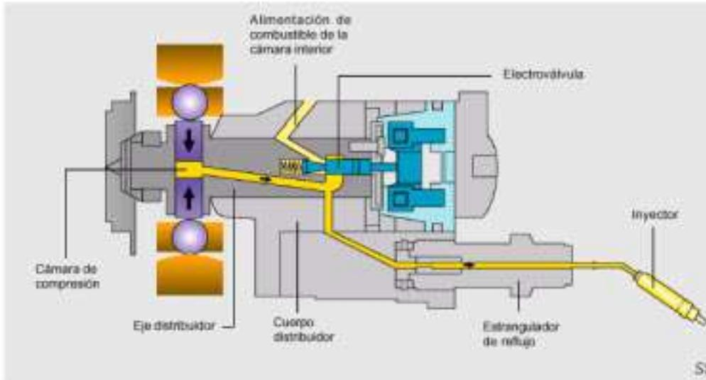
El cuerpo distribuidor tiene taladros asignados a los diferentes cilindros. El eje distribuidor gira solidariamente con el árbol de impulsión y se alterna comunicando cada vez la cámara de compresión con un taladro en el cuerpo distribuidor.
