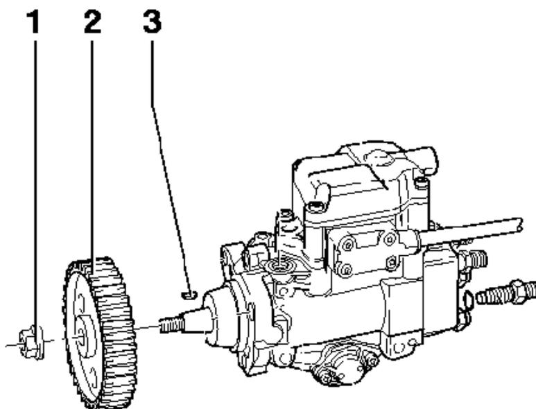
Los taladros para sujeción de la bomba al motor tienen corredera, permitiendo así el reajuste sobre la posición inicial.
