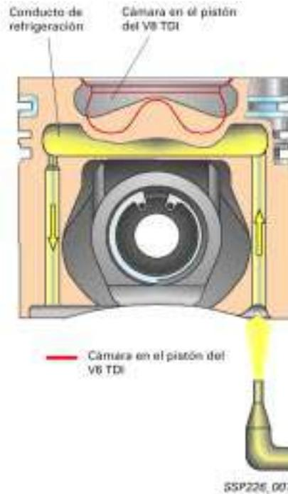
En comparación con la unión convencional entre el pistón y la biela, la geometría trapecial aumenta aquí la superficie de apoyo entre los taladros de la biela y del pistón con respecto al bulón.
