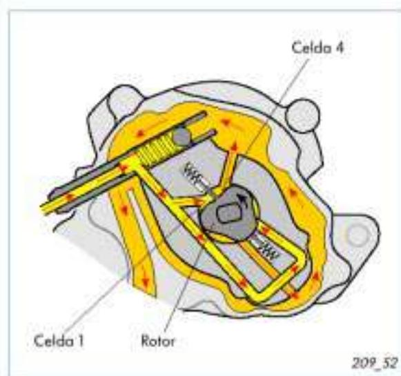
En esta figura están en acción las otras dos celdas. El combustible es impulsado por la celda 2 y aspirado por la celda 3.
