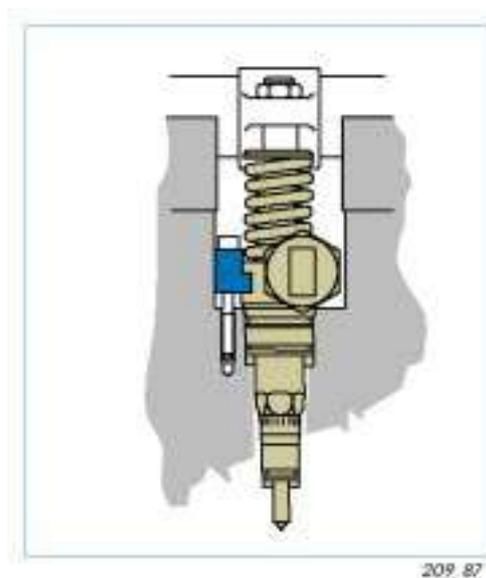
Se fija en la culata por medio de un taco tensor.
