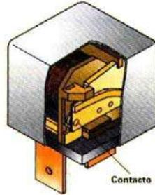
Esta alojado en la centra eléctrica de relé. Tiene un contacto de trabajo para corriente de larga duración y sirve para activar las bujías de incandescencia.
