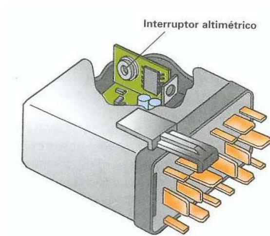
La unidad de control incorpora un interruptor altimétrico que informa en todo momento de la presión atmosférica. La cual esta relacionada con las condiciones meteorológicas y la posición del vehículo respecto al nivel del mar.
