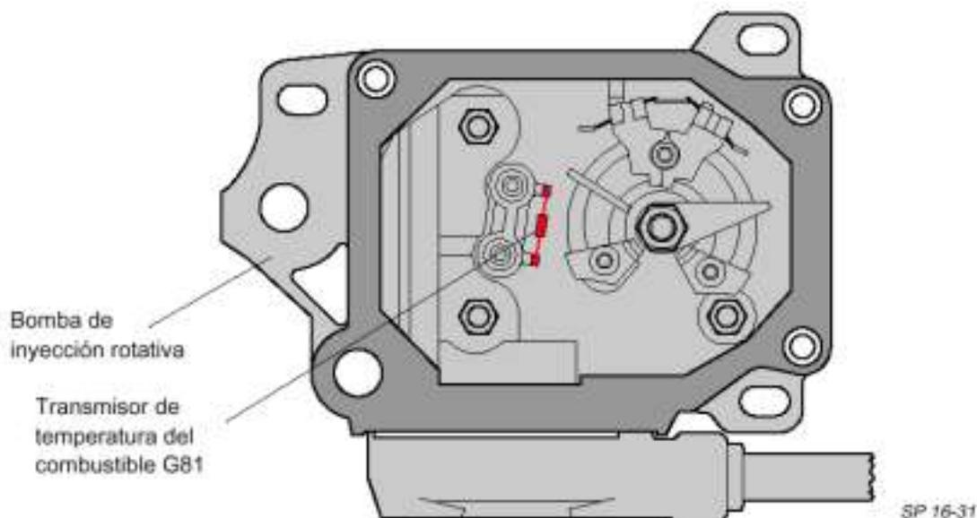
La temperatura del combustible es muy importante porque la densidad del mismo depende directamente de su temperatura. Un pequeño émbolo de la bomba de inyección impele a gran presión el combustible a través de los inyectores. A fin de determinar exactamente el caudal de inyección y el comienzo de ésta, se ha de conocer la temperatura del combustible. Mediante la relación conocida entre temperatura y densidad se pueden calcular los valores correctos.
