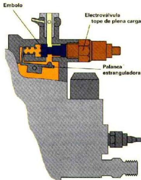
La electroválvula tope de plena carga está ubicada en la parte superior de la bomba de inyección, en la tapa del regulador. Esta configurada de tal forma que controla el caudal de retorno, tiene dos únicas posiciones, totalmente abierta o con apertura mínima.
