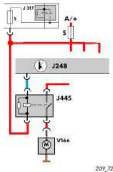
**NOTA:** Con la función de diagnóstico de actuadores se puede verificar si la unidad de control excita el relé para la bomba de refrigeración del combustible.
