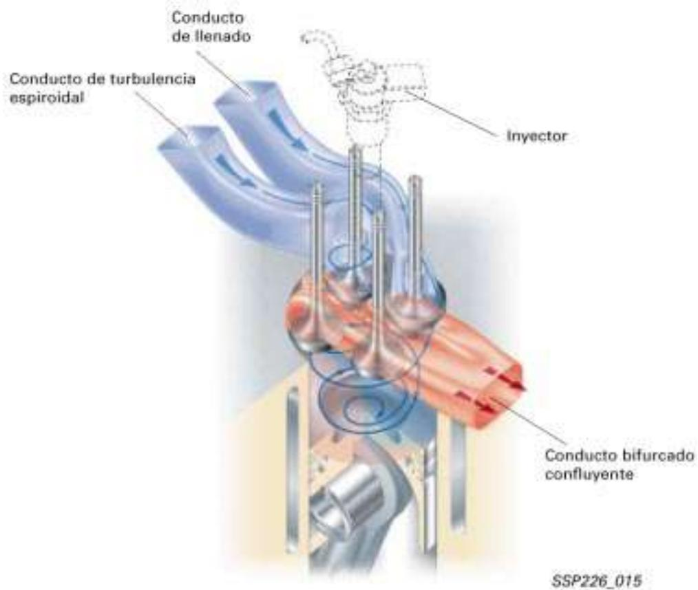
Se ha adoptado sin modificaciones la configuración de las 4 válvulas ya conocida en el motor V6 TDI, con:
