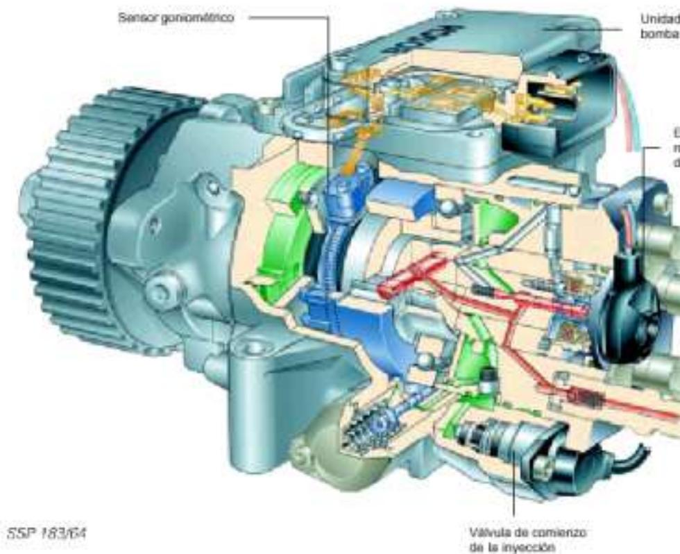
No pueden efectuarse reparaciones en la bomba de inyección rotativa de émbolos radiales. Si la bomba se avería deberán observarse las indicaciones proporcionadas al respecto en el Manual de Reparaciones.
