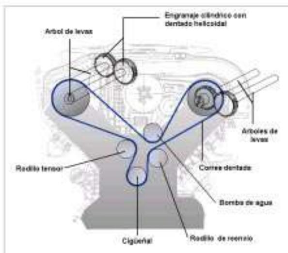
El segundo árbol de levas se impulsa por medio de un engranaje cilíndrico con dentado helicoidal. Eso hace que los árboles de levas giren en dirección opuesta.
