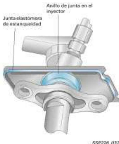
Los inyectores están sellados con una arandela de estanqueidad hacia la cámara de combustión. Si surge una inestabilidad, la sobrepresión de la combustión puede escapar a la atmósfera a través del conducto correspondiente.
