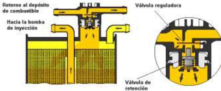
Cuando la temperatura exterior aumenta, la válvula reguladora esta en posición de reposo y por ello el combustible retorna al depósito sin precalentar el filtro.
