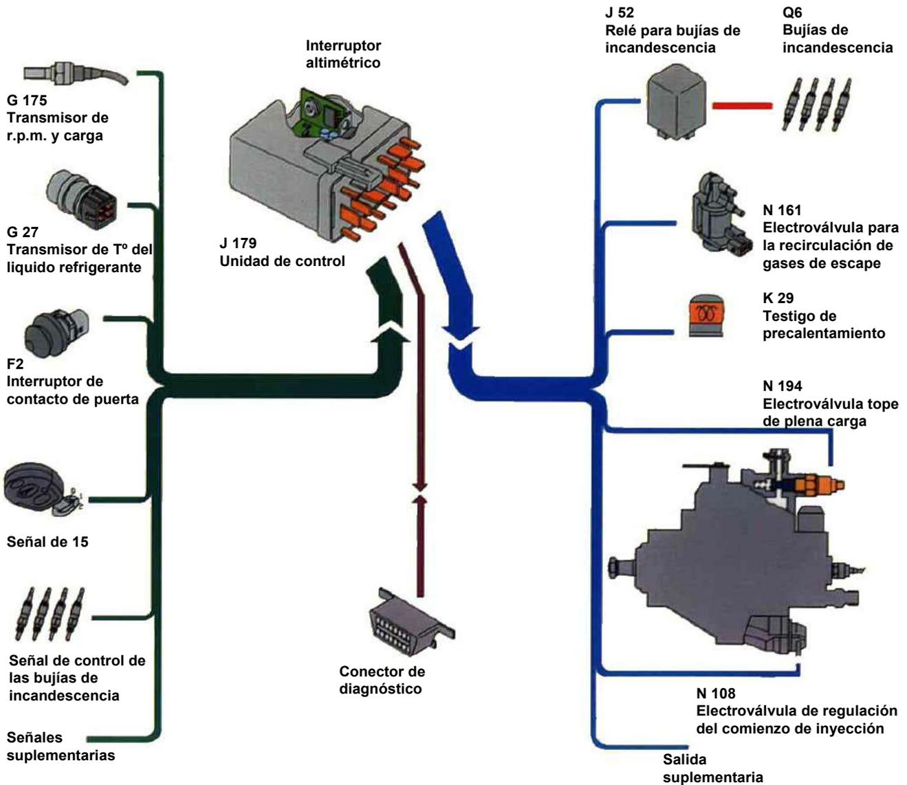
La tarea principal de la regulación electrónica diesel integrada en todo el sistema es la influencia sobre la inyección de combustible en determinadas condiciones de funcionamiento como
