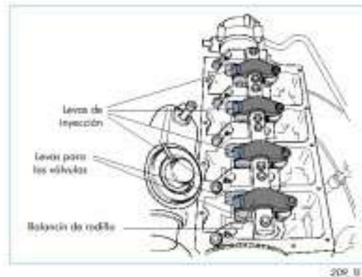
El balancín con rodillo dispone de un tornillo de regulación, para ajustar el juego existente entre el mismo y el inyector bomba. El ajuste será necesario realizarlo siempre que se desmonte el inyector bomba o se sustituya algún elemento que participa en su accionamiento.
