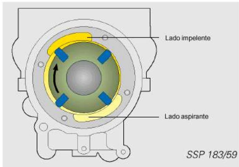
La presión en la bomba de inyección rotativa de émbolos radiales impele el combustible hacia la cámara de compresión, estando abierta la electroválvula.
