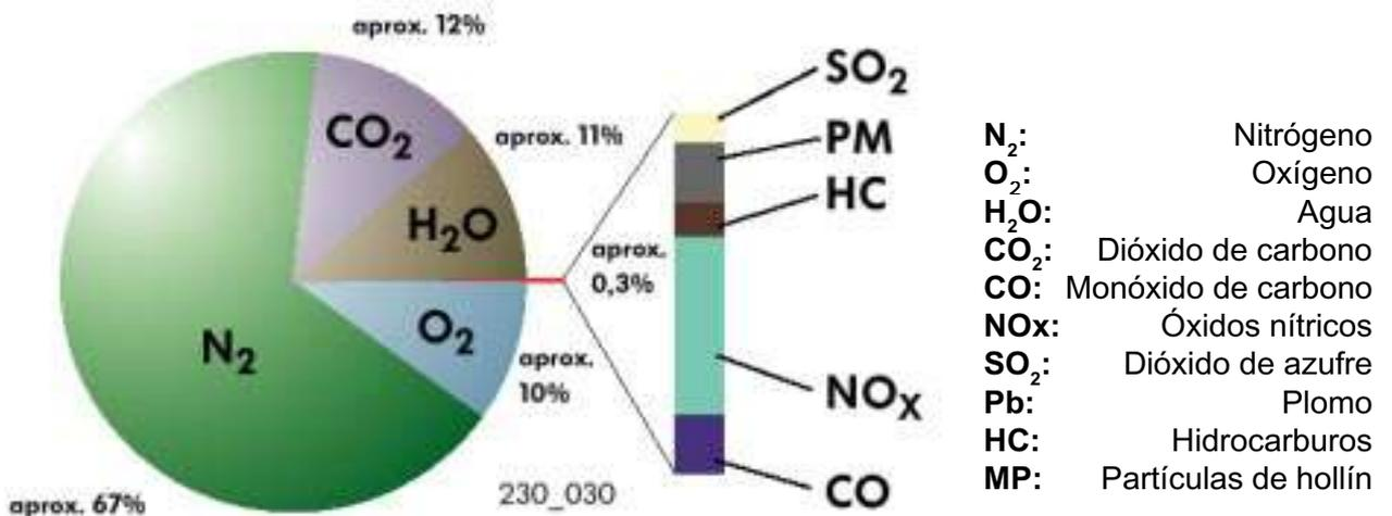
Composición de los gases de escape en motores diesel
