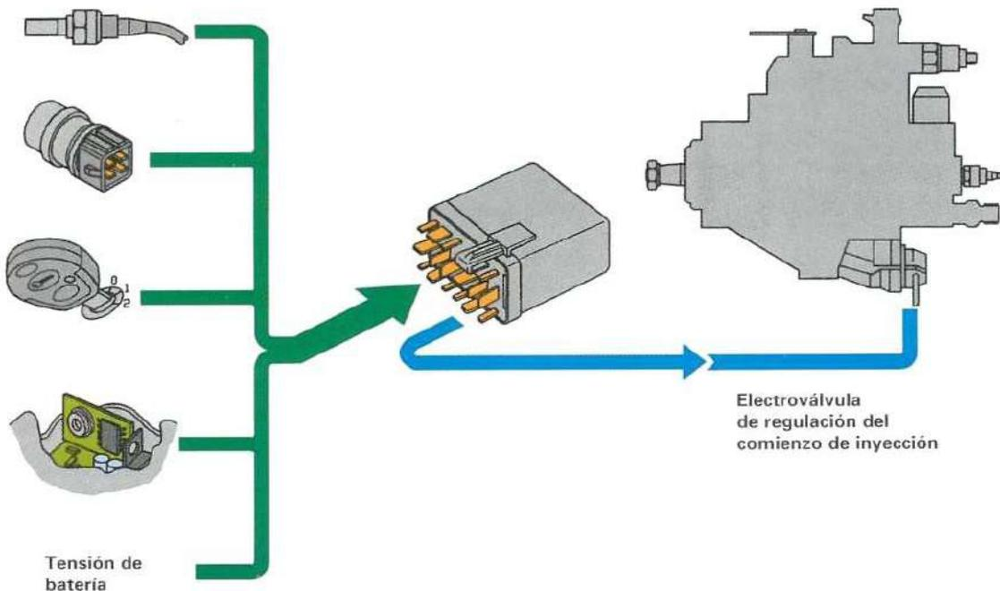
Para calcular la señal eléctrica que debe enviar a la electroválvula, la unidad de mando necesita conocer r.p.m.,  $T^{\circ}$  del motor, borne 15, presión atmosférica y tensión de batería.
