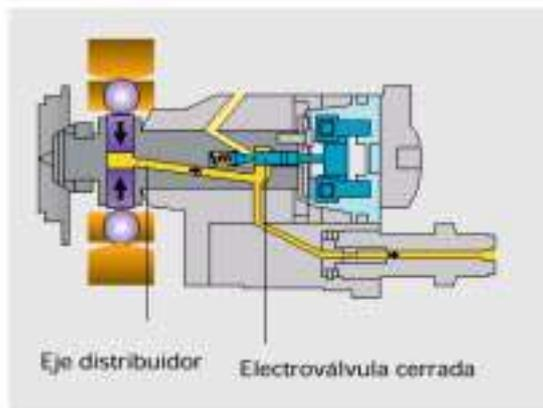
El volumen de combustible a plena carga es de aproximadamente  $50 \text{ mm}^3$  por ciclo de inyección. Esto equivale al contenido de una gota de agua.
