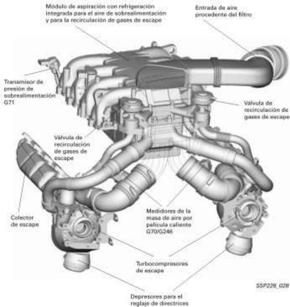
La regulación de la sobrealimentación se efectúa detectando específicamente la cantidad de aire para cada fila de cilindros, utilizando para ello dos medidores de la masa de aire por película caliente.
