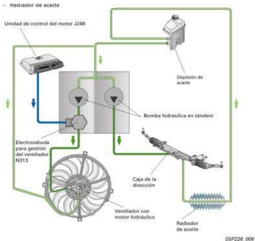
Con la bomba hidráulica en tándem, accionada por medio de la correa Poly-V, se alimenta simultáneamente presión de aceite para la servodirección y para el ventilador hidráulico.
