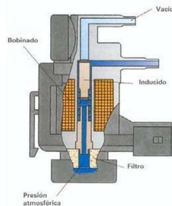
Situada delante de la caja del vierteaguas, junto al deposito de expansión del circuito de refrigeración. La electroválvula tiene la función de gobernar la válvula neumática de la recirculación de los gases de escape.
