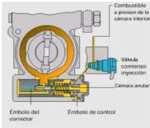
El émbolo de control, alojado en el corrector de la inyección, es oprimido por la fuerza del muelle de compresión contra el émbolo del corrector. A través de un taladro se suministra combustible a presión hacia la cámara anular del émbolo de control, procedente del interior de la bomba de inyección. La válvula de comienzo de la inyección define la presión del combustible en la cámara anular del émbolo de control.
