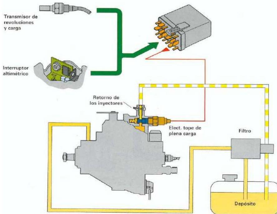
En grandes altitudes y debido a la menor densidad del aire, la masa de aire aspirado es también menor. El caudal de combustible inyectado no se puede quemar, se producen humos, y aumenta la T° del motor. Para evitarlo se ha dotado a la unidad de mando con la función de limitación del caudal de inyección, para ejecutar esta función la unidad de mando necesita los siguientes datos: r.p.m. y presión atmosférica.
