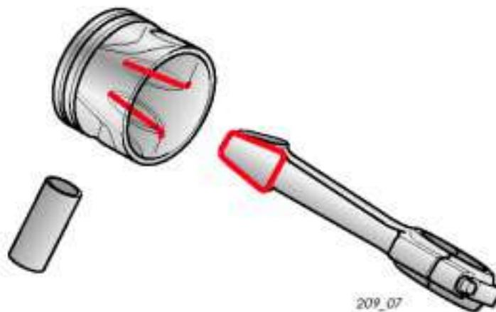
En comparación con la unión convencional entre el pistón y la biela, la geometría trapecial permite aumentar la superficie de apoyo de la cabeza de la biela y del cubo del pistón con respecto al bulón. De esta forma, las fuerzas de la combustión se reparten sobre una mayor superficie, sometiéndose al bulón y la biela a un menor índice de solicitaciones.
