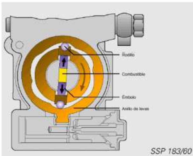
La rotación del árbol de impulsión hace que las levas interiores del anillo actúen contra los rodillos, oprimiendo así los émbolos hacia el interior. En virtud de ello se comprime el combustible entre los émbolos.
