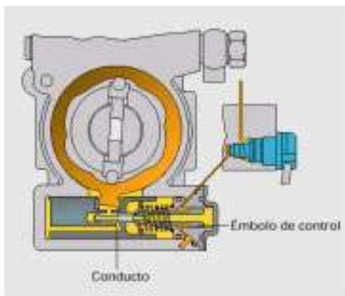
La válvula de comienzo de la inyección aumenta la presión del combustible en la cámara anular a medida que aumenta el régimen de revoluciones. En virtud de ello, el émbolo de control despega del émbolo del corrector, superando la presión del muelle y abre el paso de un conducto. El combustible ingresa detrás del émbolo corrector.
