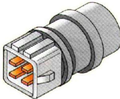
El transmisor de temperatura esta situado en el tubo de salida de la culata hacia el radiador. Está diseñado como resistencia NTC, lo que significa que su resistencia disminuye al aumentar la T°.
