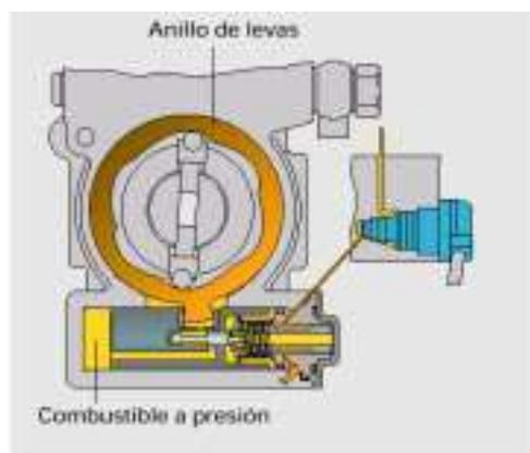
La presión del combustible desplaza el émbolo del corrector hacia la derecha. El émbolo del corrector está comunicado con el anillo de levas, de modo que el movimiento horizontal del corrector produce un movimiento giratorio del avance en el anillo de levas.
