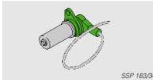
En los vehículos equipados con cambio manual, el transmisor de régimen del motor toma lectura de seis rebajes practicados en el volante de inercia.
