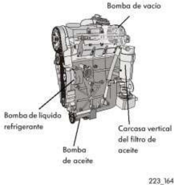
Dentro de esta serie EA 188, se encuentran tanto los motores de cuatro cilindros con bomba rotativa, como los motores con inyector bomba de cuatro y de tres cilindros.
