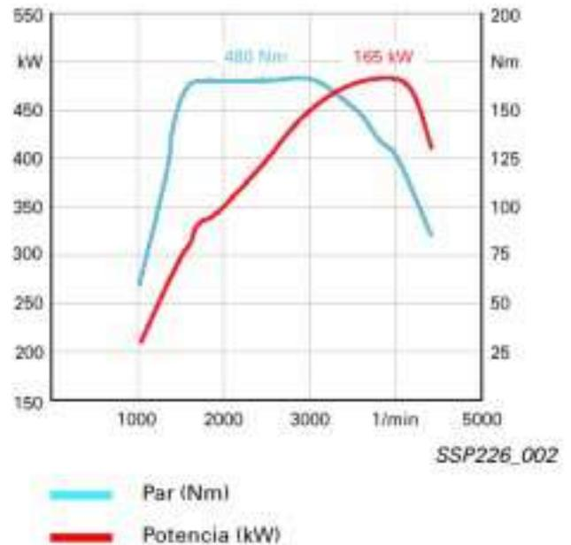
El par máximo de 480 Nm ya se alcanza a las 1.800 1/min y se mantiene constante a este alto nivel hasta las 3.000 1/min. La potencia máxima es de 165 kW a las 4.000 1/min.
