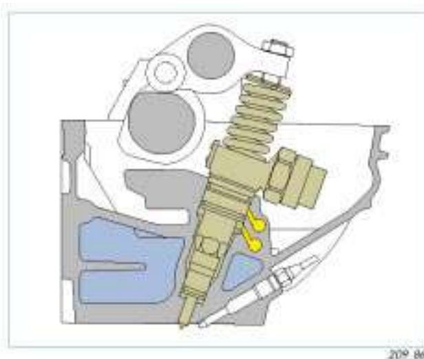
El inyector bomba se monta directamente en la culata.
