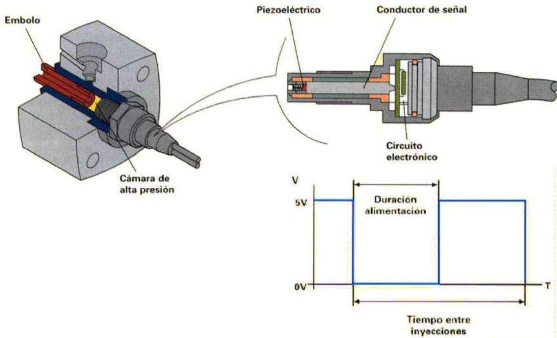
Es utilizado para definir el número de revoluciones del motor y el caudal de inyección de combustible inyectado por la bomba de inyección.
